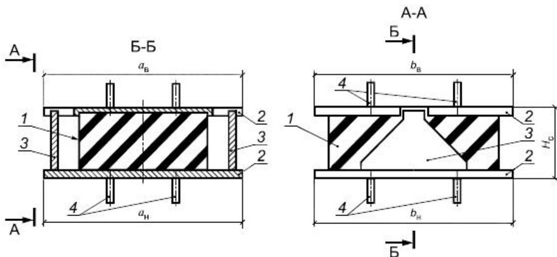
1 – резиновая опорная часть; 2 – закладные детали в пролетном строении и опоре; 3 – ограничители перемещения (упоры); 4 – анкера;  $a_в, a_н, b_в, b_н$  – размеры верхней и нижней закладных деталей в плане;  $H_с$  – высота опорной части с закладными деталями
