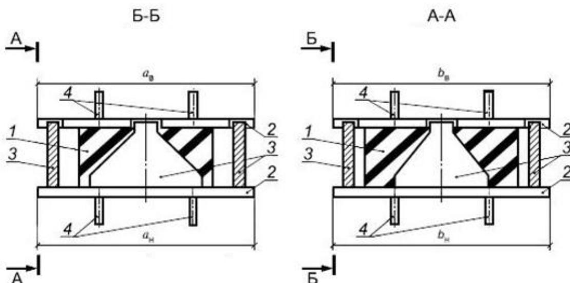
1 – резиновая опорная часть; 2 – закладные детали в пролетном строении и опоре; 3 – ограничители перемещения (упоры); 4 – анкера;  $a_{\text{в}}$ ,  $a_{\text{н}}$ ,  $b_{\text{в}}$ ,  $b_{\text{н}}$  – размеры верхней и нижней закладных деталей в плане;  $H_{\text{с}}$  – высота опорной части с закладными деталями
