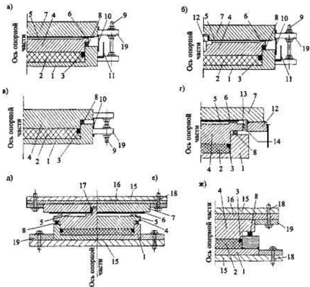
а – всесторонне-подвижная; б – линейно-подвижная с направляющими элементами в середине крышки; в – неподвижная; г – линейно-подвижная с направляющими элементами с наружных сторон крышки; д, е, ж – линейно-подвижная, всесторонне-подвижная и неподвижная с элементами анкерного крепления;
