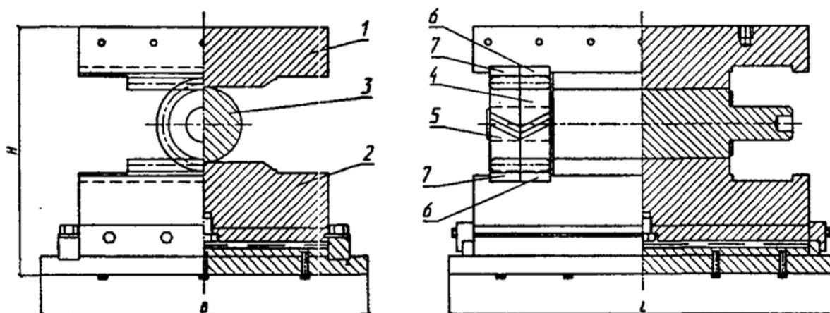
1, 2 – опорные плиты; 3 – каток; 4,5 – зубчатые колеса; 6,7 – зубчатые рейки
