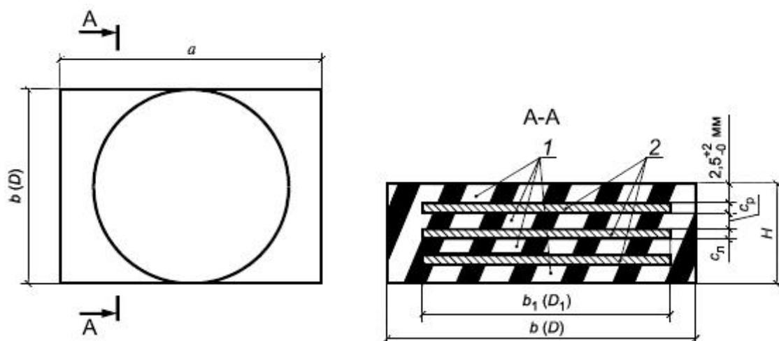
1 – резина; 2 – промежуточные стальные листы;  $a$ ,  $b (D)$  – размеры опорной части в плане;  $a_1$ ,  $b_1 (D_1)$  – размеры в плане стальных листов;  $c_{л}$  – толщины стальных листов;  $c_{р}$  – толщины промежуточных слоев резины;  $H$  – высота опорной части
