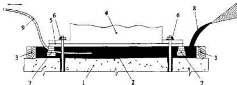
1 – подферменник; 2 – выравнивающий слой; 3 – опалубка; 4 – опорная часть; 5 – анкерная плита; 6 – анкерные болты; 7 – клинья; 8 – бетонная смесь; 9 – гибкий стальной трос (набор мелких стальных цепей)
