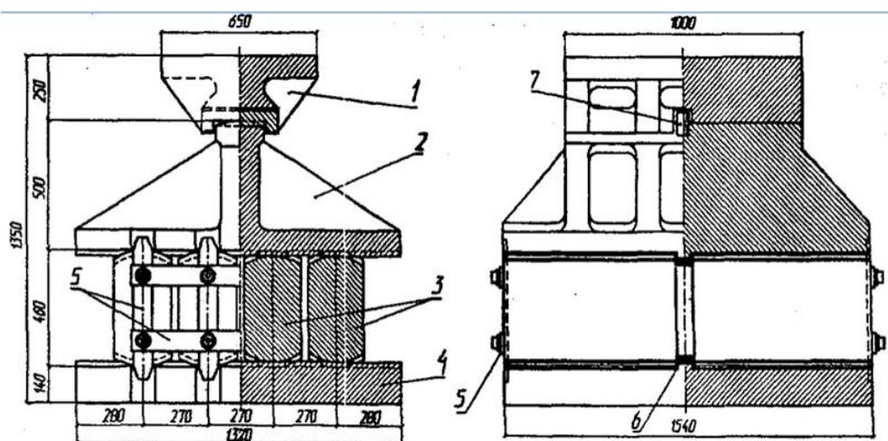
1 – верхний балансир; 2 – нижний балансир; 3 – катки; 4 – опорная плита; 5 – противоугонные планки и накладки; 6 – гребень опорной плиты; 7 – шпонка
