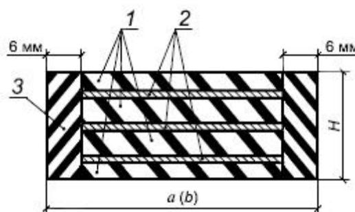
1 – свето- и озоностойкая резина; 2 – стальные листы; 3 – защитный слой из озоностойкой резины; a, b – размеры опорной части в плане; H – высота опорной части
