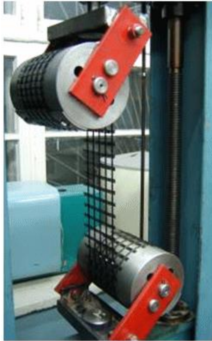
Рисунок Г.1 Определение предела прочности ГМ при растяжении
