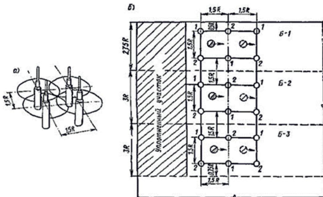
а) – схема перестановки вибраторов с одной позиции на другую; б) – принципиальная схема расстановки и перемещения бетонщиков с вибраторами при уплотнении бетонной смеси;
