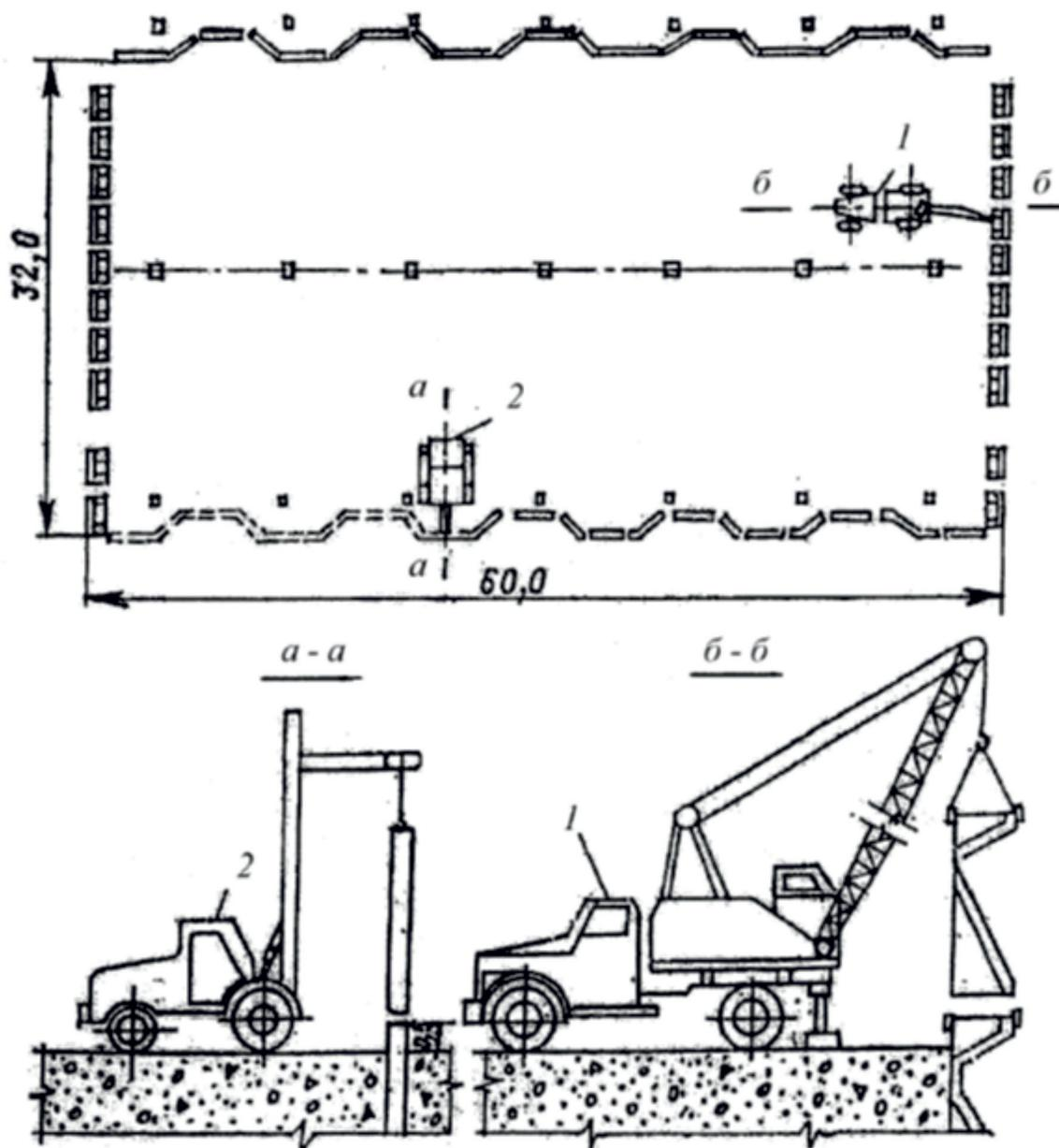
1 – автокран грузоподъемностью 7 т; 2 – автопогрузчик грузоподъемностью 5 т
