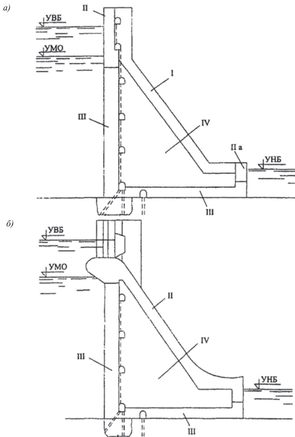
а) – глухая плотина; б) – водосливная плотина;
