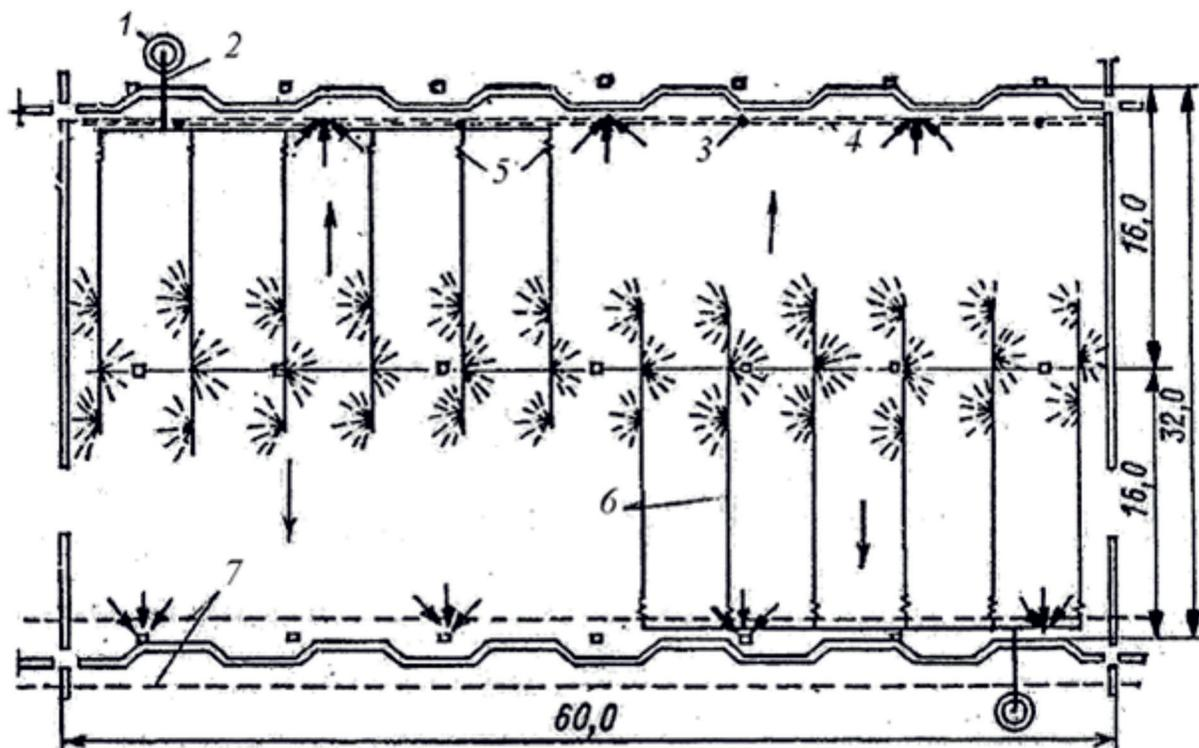
1 – колодец; 2 – трубы 50 мм; 3 – скважины 100 мм; 4 – канализационная труба;
