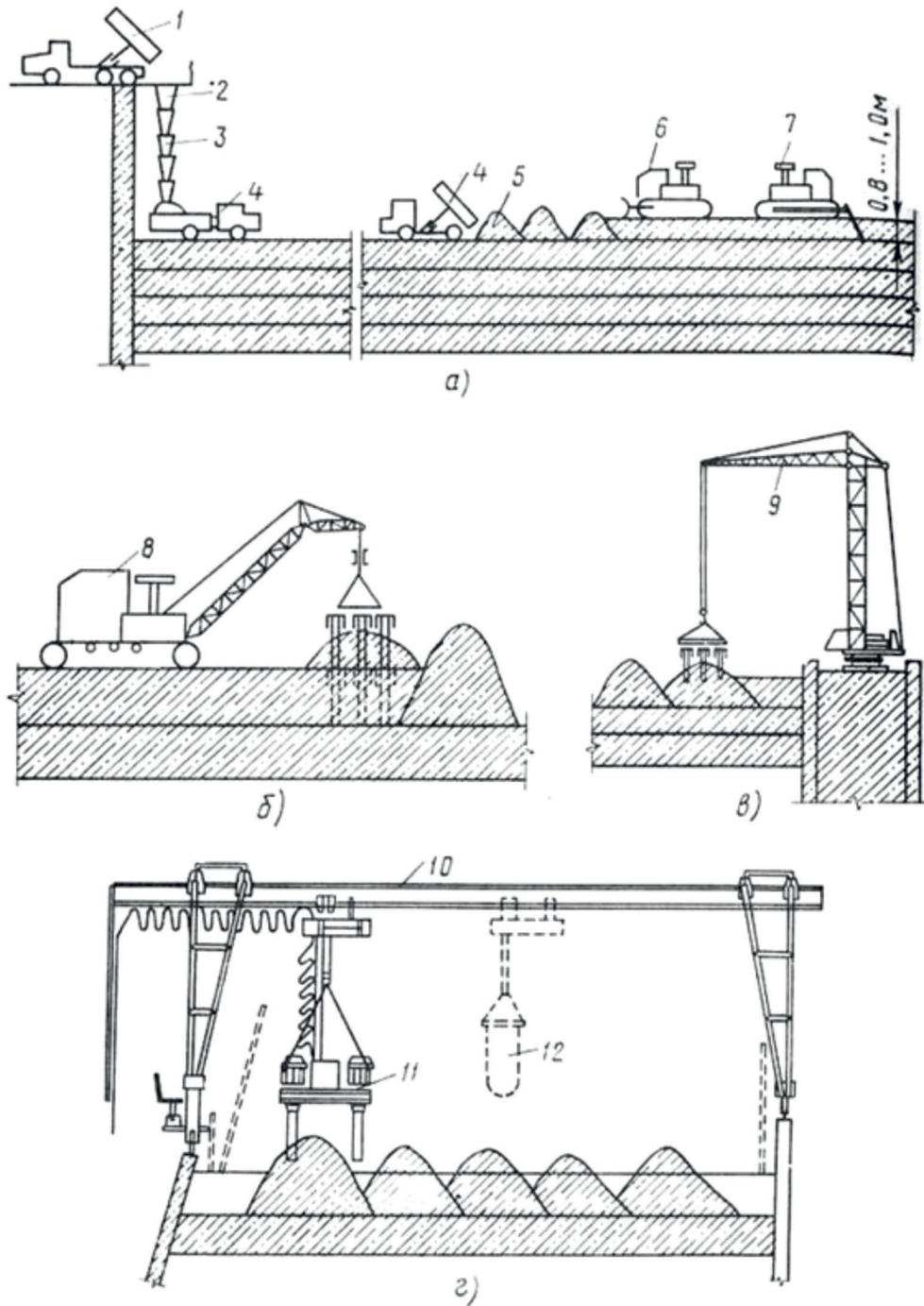
а) – уплотнение слоев смеси пакетом вибраторов, установленных на тракторе;
