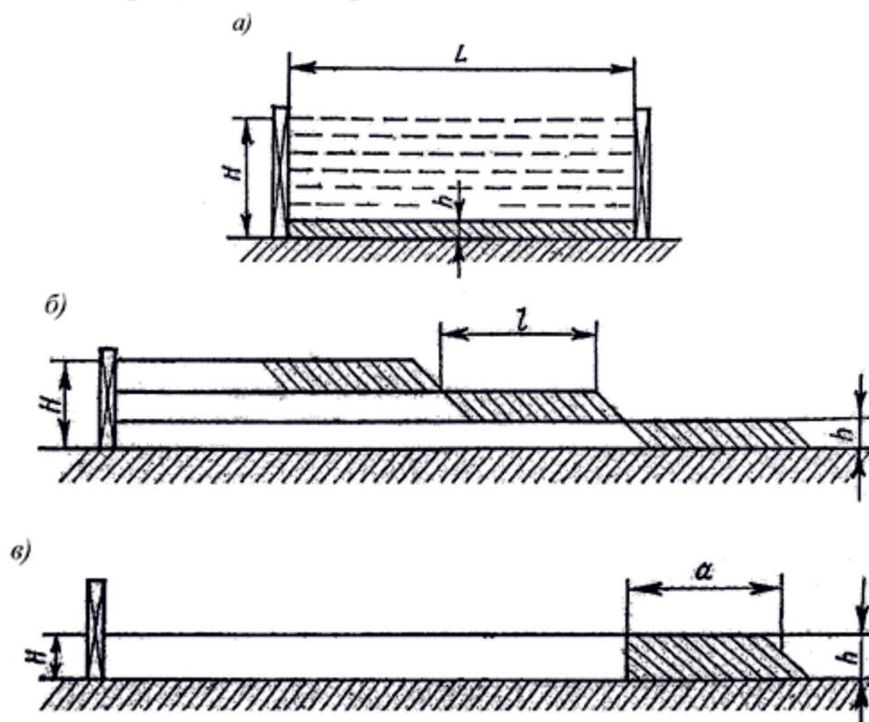
*а*) – последовательными горизонтальными слоями; *б*) – схема ступенчатого бетонирования;
