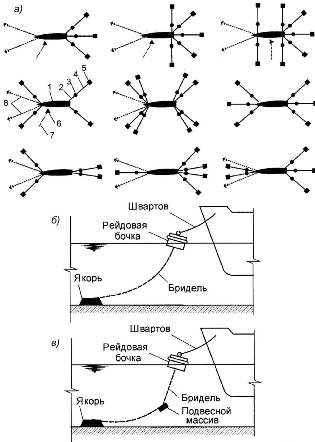
а) – схемы причалов; б) – рейдовая бочка со свободно провисающим бриделем; в) – рейдовая бочка со свободно провисающим бриделем и подвесным массивом
