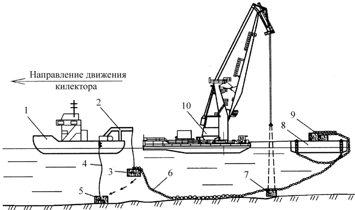
1 – килекторное судно; 2 – крамбол; 3 – железобетонный якорь; 4 – веха с тросовым бриделем и якорем; 5 – проектное положение якоря; 6 – якорная цепь; 7 – подвесной массив; 8 – понтон; 9 – якорные связи противоположного борта понтона; 10 – плавкран
