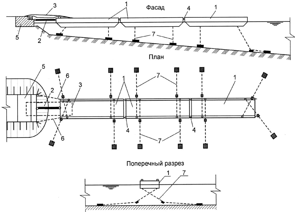
1 – понтон; 2 – соединительная штанга; 3 – табельный мост; 4 – межпонтонные (межсекционные) шарниры; 5 – береговой устой корневой части; 6 – страховочные цепи; 7 – якорные связи
