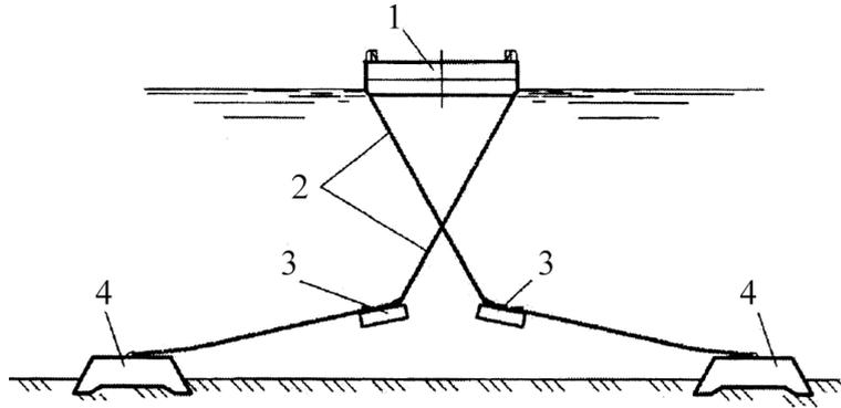
1 – плавучее сооружение; 2 – якорный канат (цепь, трос, канат); 3 – подвесной груз (массив, блок);
