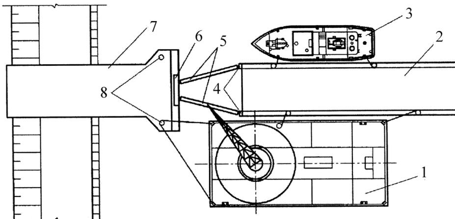
1 – плавкран; 2 – корневой понтон; 3 – буксир; 4 – кронштейны понтона; 5 – штанги; 6 – береговой лежень; 7 – береговая корневая часть; 8 – швартовные тумбы береговой корневой части
