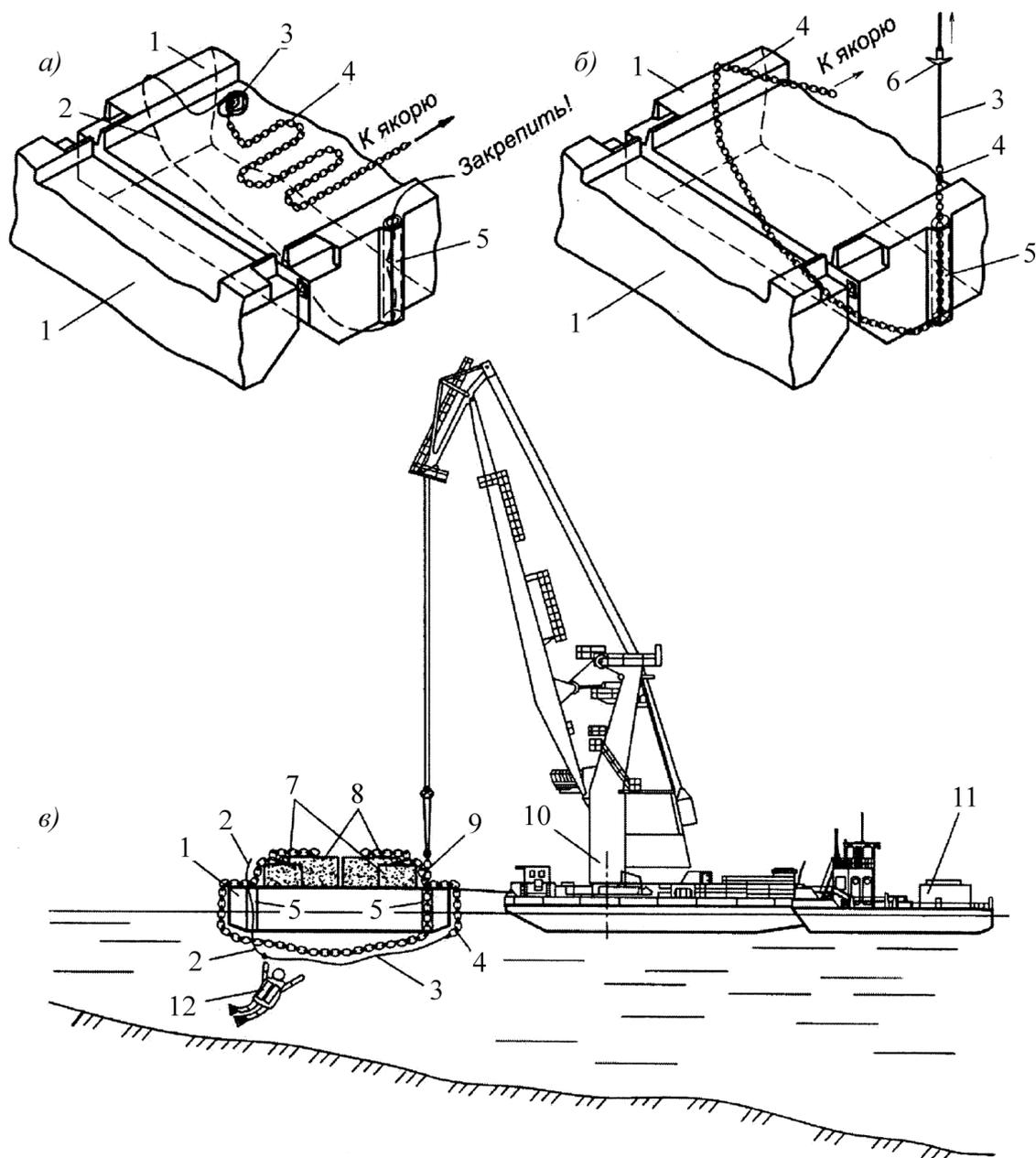
1 – понтон; 2 – капроновый канат (проводник) с концевой скобой; 3 – стальной трос (проводник);
