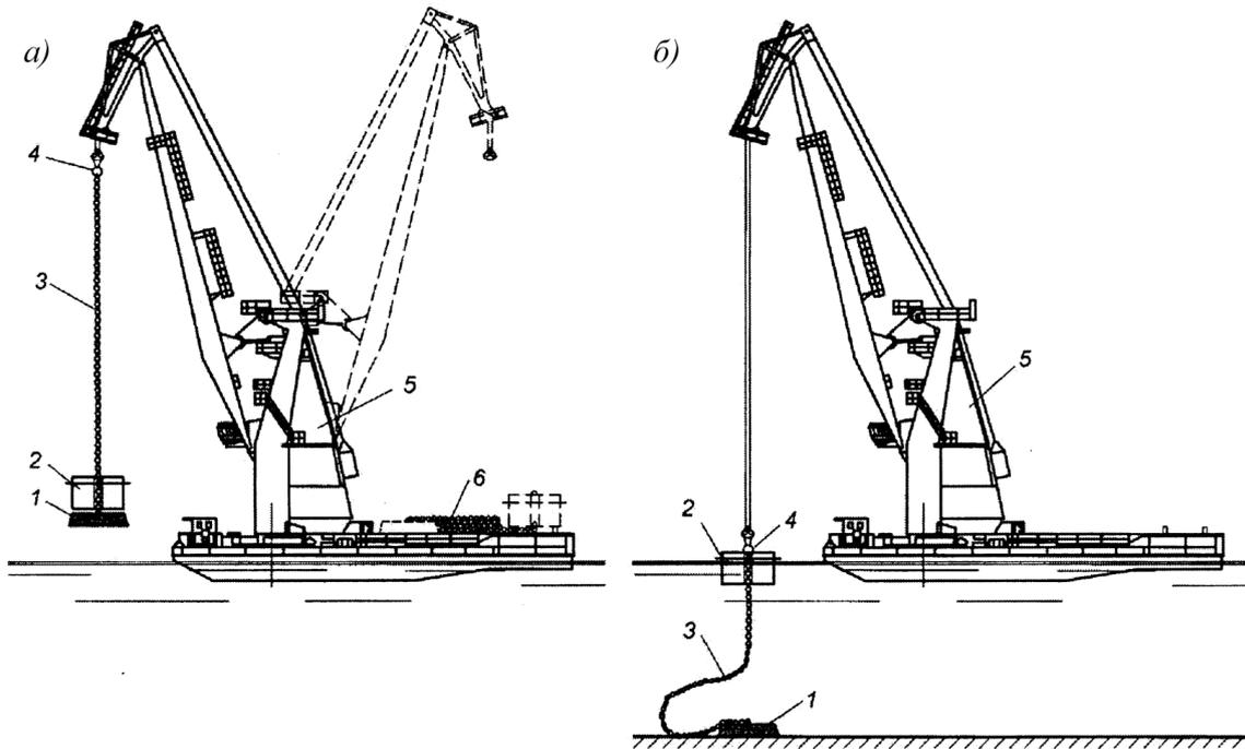
1 – якорь; 2 – рейдовая бочка; 3 – бридель; 4 – стопорное кольцо; 5 – плавучее грузоподъемное средство;
