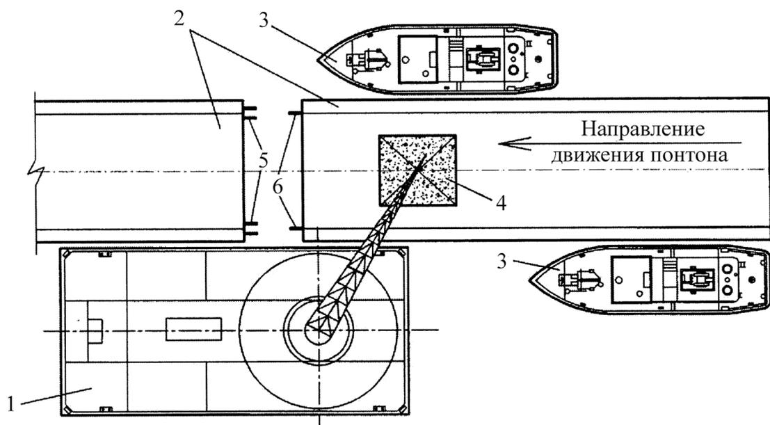
1 – плавучий кран; 2 – стыкуемые понтоны причала; 3 – буксир; 4 – пригрузочный массив;
