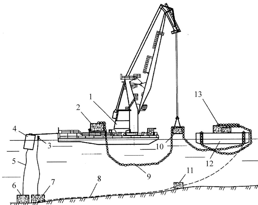
1 – плавкран; 2 – железобетонный якорь; 3 – вежа с тросовым биделем и якорем в месте установки якоря причала; 4 – рейдовая бочка; 5 – бидель рейдовой бочки; 6 – якорь рейдовой бочки; 7 – проектное положение якоря причала; 8 – проектное положение якорной цепи; 9 – якорная цепь; 10 – подвесной массив; 11 – проектное положение подвесного массива; 12 – понтон; 13 – якорные связи противоположного борта понтона
