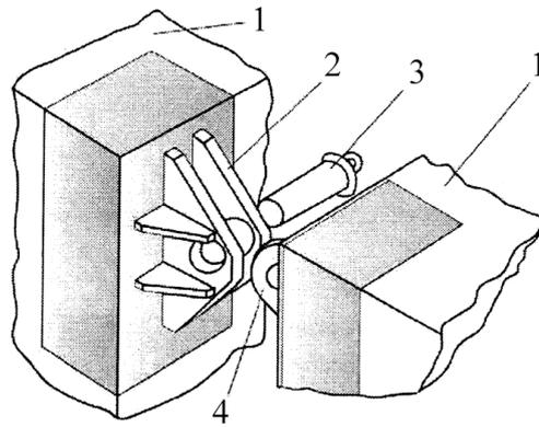
1 – стыкуемый понтон секции; 2 – кормовой кронштейн понтона; 3 – соединительный палец;
