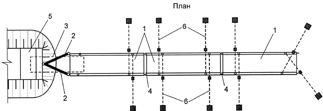
1 – понтон; 2 – соединительная штанга; 3 – табельный мост; 4 – межпontonные (межсекционные) шарниры; 5 – береговой устой корневой части; 6 – якорные цепи
