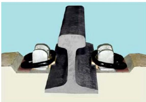
Рисунок 15 – Безрезьбовое упругое нераздельное рельсовое крепление с прутковыми торсионными клеммами для железобетонных шпал. Подкладка и клеммы крепятся к омоноличенному в шпале анкеру при помощи эксцентрикового регулятора, это крепление характеризуется простотой монтажа, малодетальностью и высокой надежностью
