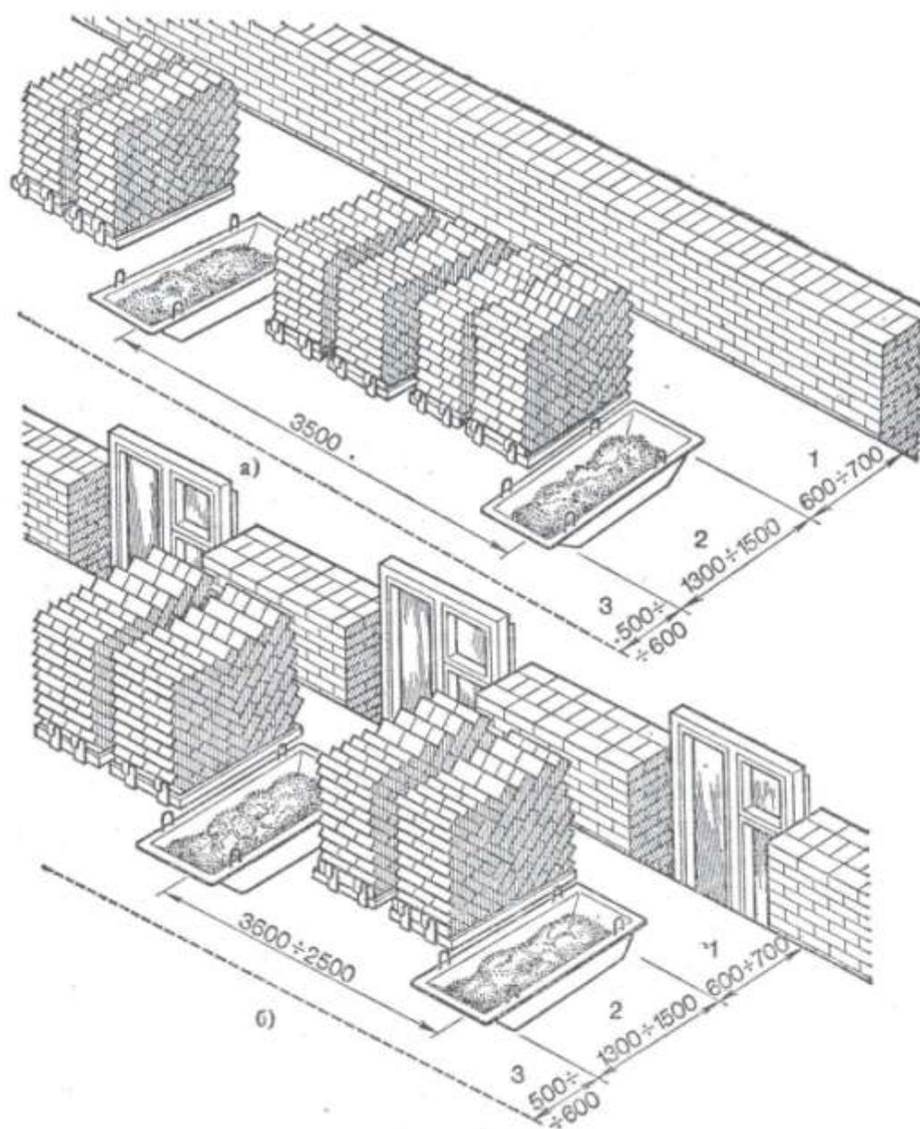
а – при кладке сплошных стен; б – при кладке стен с проемами; зоны: 1 – рабочая, 2 – материалов, 3 – транспортная.
