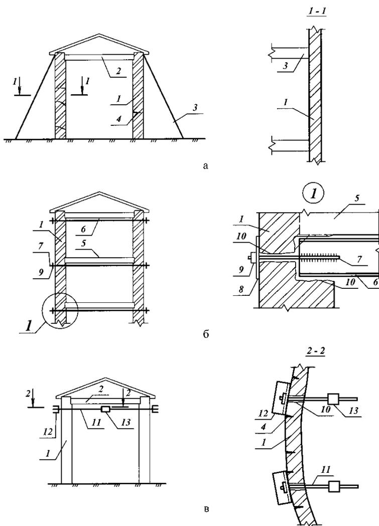
а – возведением контрфорсов; б – установкой поэтажных связей-распорок; в – установкой металлических тяжей; 1 – стены, отклонившиеся от вертикального положения; 2 – покрытие; 3 – контрфорсы из кирпичной кладки или бетона; 4 – трещины в кладке; 5 – перекрытия; 6 – связи-распорки из прокатного стального профиля; 7 – тяж с резьбой, приваренный к связям-распоркам; 8 – шайба; 9 – гайка для натяжения; 10 – отверстия и ниши в стенах; 11 – тяжи; 12 – траверса из швеллера; 13 – натяжная муфта
