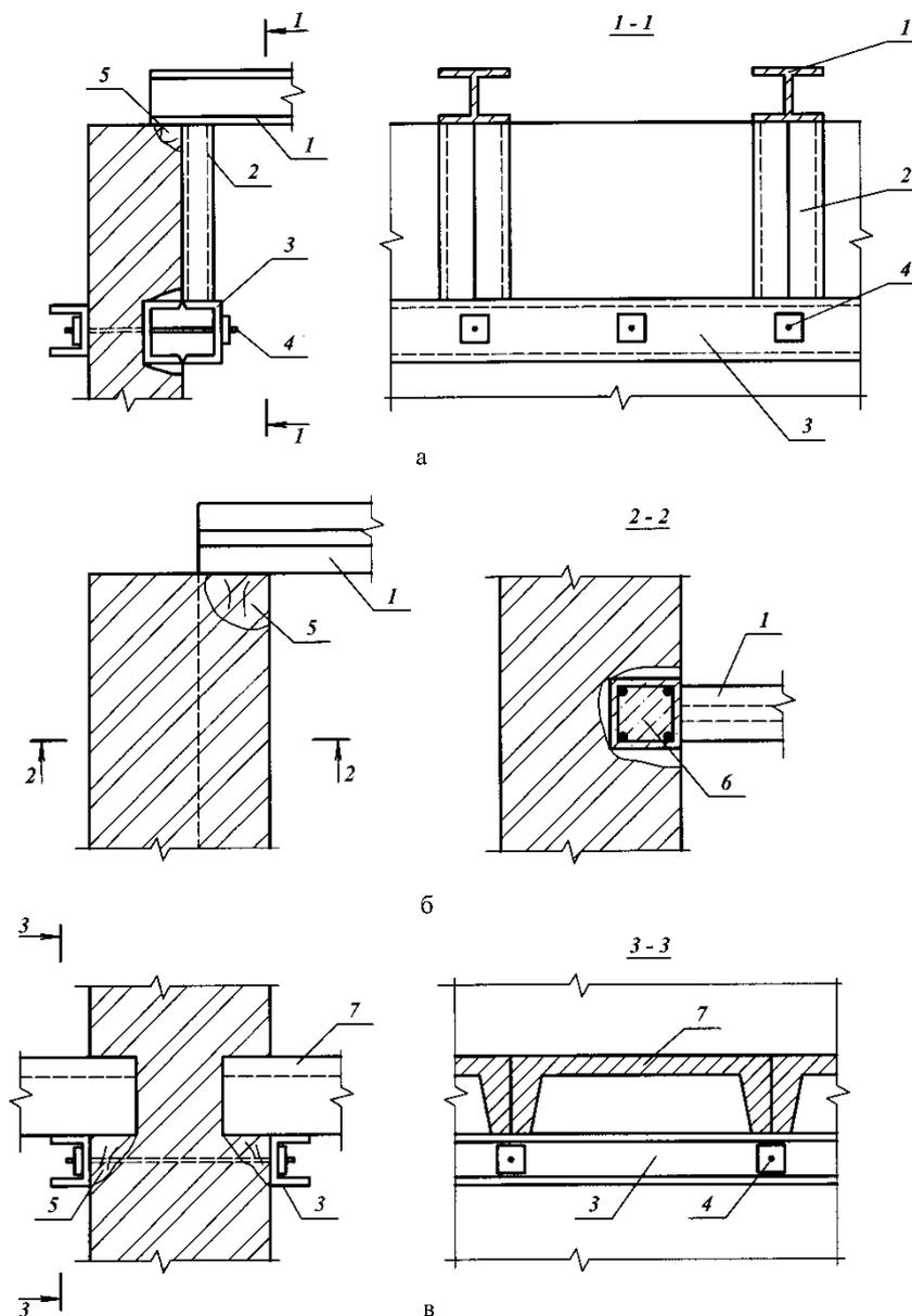
а – короткими стойками; б – врезной стойкой; в – стальным поясом;
