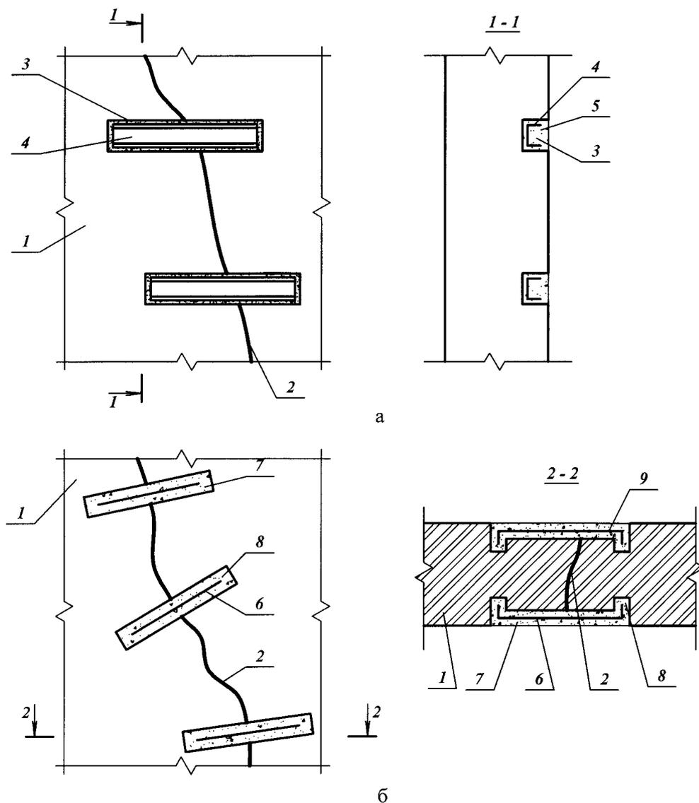
а – установкой шпонок из прокатного металла; б – то же скоб из арматурных стержней; 1 – усиливаемая стена; 2 – трещина в кладке шириной до 10 мм, инъецированная цементно-песчаным раствором после установки шпонок; 3 – штраба в стене; 4 – шпонка из прокатного металла (швеллер, уголок); 5 – полости заполненные бетоном или раствором; 6 – скобы из арматурных стержней; 7 – паз в кладке, выбранный фрезой; 8 – углубления по концам паза, выполненные сверлом; 9 – заполнение раствором пазов и углублений
