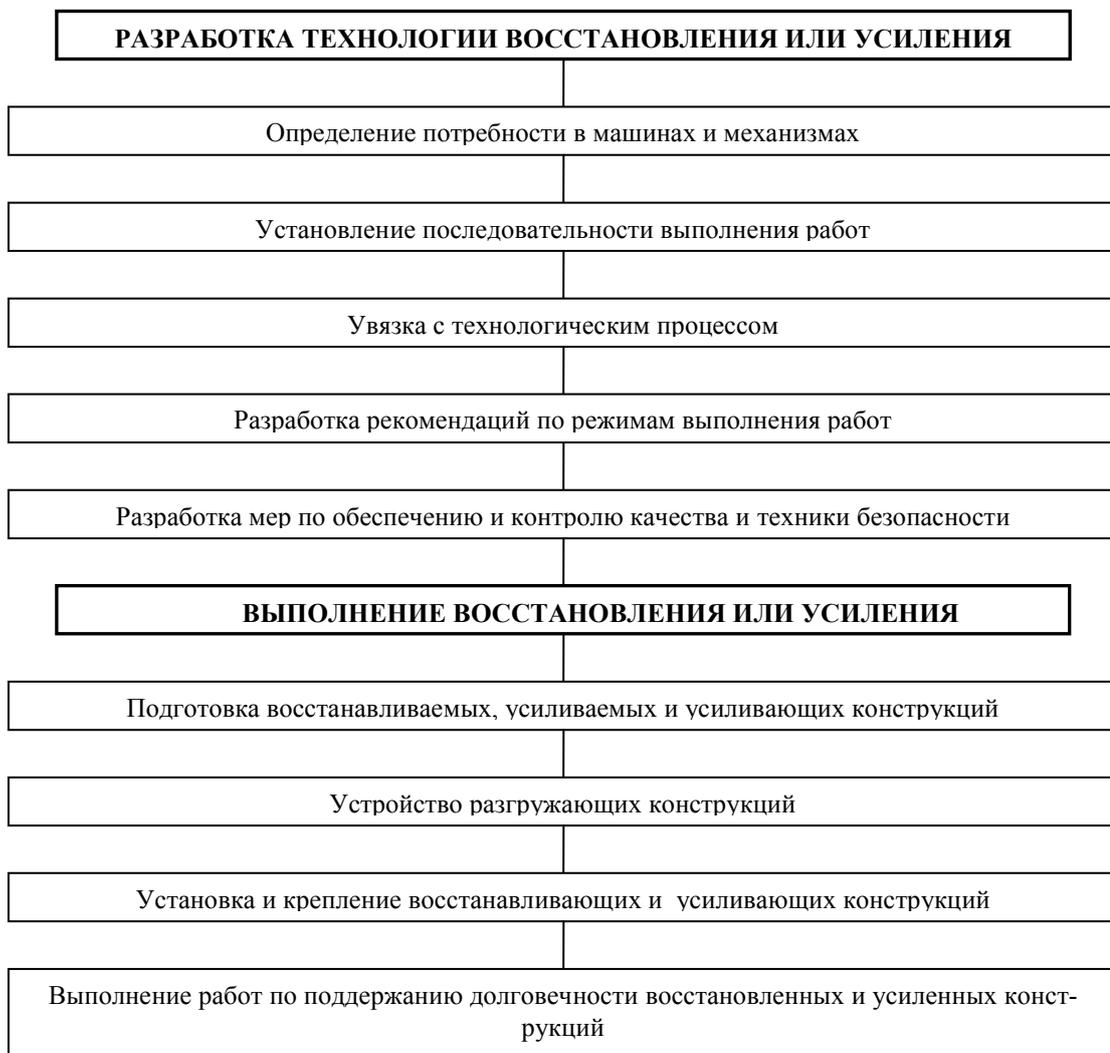
Рисунок 8.1 - Последовательность выполнения работ по восстановлению и усилению конструкций
