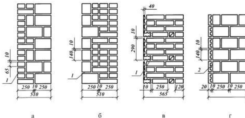
а – лицевым кирпичом стены из керамических камней; б – лицевыми керамическими камнями стены из кирпича; в – закладными керамическими плитами стены из кирпича; г – прислонными керамическими плитами стены из керамических камней; 1 – раствор не ниже марки М25; 2 – то же, не ниже М50
