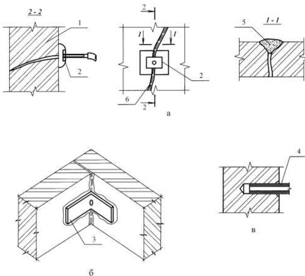
а, б – через шайбу или уголок; в – через штуцер; 1 – стена с трещиной; 2 – шайба; 3 – уголок; 4 – штуцер; 5 – герметизация; 6 – трещина; 7 – гибкий шланг
