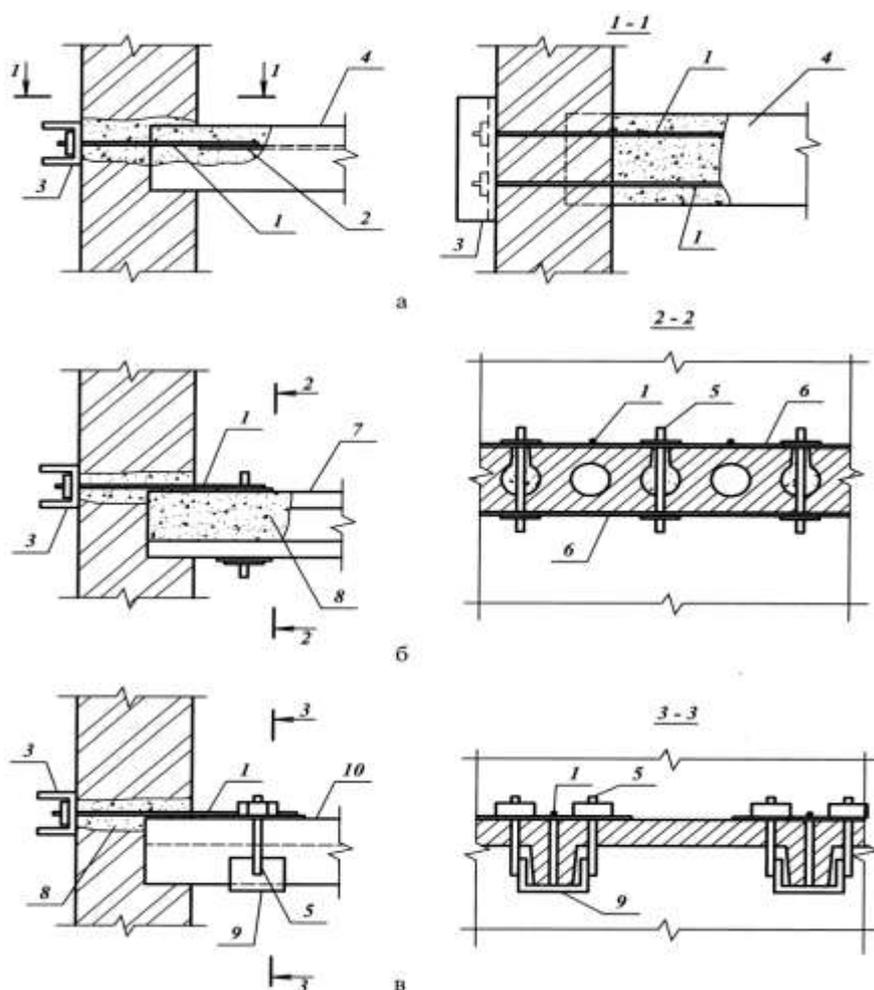
а – балок; б – пустотных плит; в – ребристых плит; 1 – анкерный стержень  $\text{Ø}20\dots25$ ; 2 – арматурные стержни балки; 3 – отрезок швеллера  $\text{I}12\dots14$ ; 4 – балка перекрытия;
