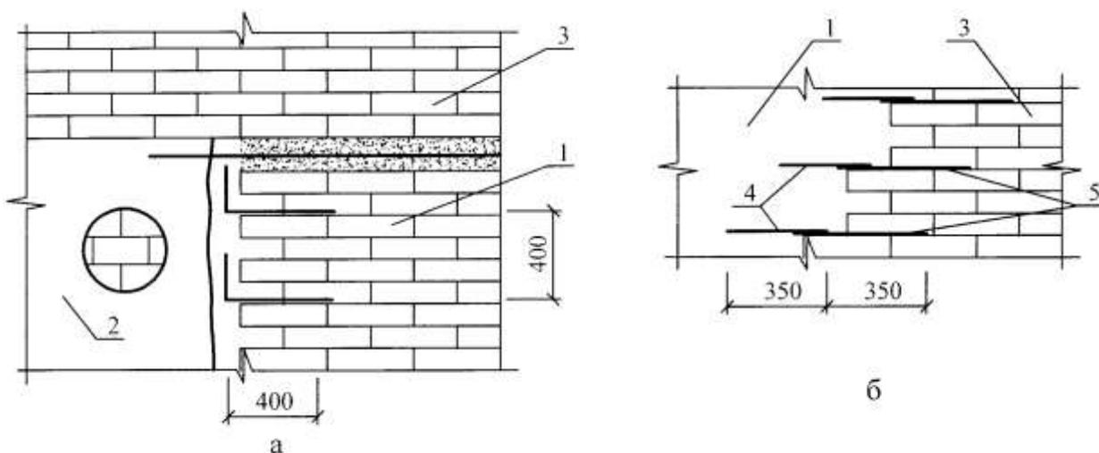
а – при поэтапной кладке; б – при соединении со старой кладкой; 1 – новая кладка; 2 – кладка, укладываемая во вторую очередь; 3 – старая кладка; 4 – арматурная сетка Ø4 В500, Вр500 с ячейкой 100x100 мм; 5 – арматурные стержни Ø6 А240
