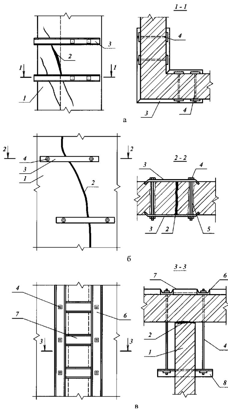
а, б – стальными накладками; в – стяжными болтами; 1 – усиливаемая стена; 2 – трещина в кладке; 3 – стальные накладки; 4 – стяжные болты; 5 – отверстия в стене для болтов; 6 – продольные накладки; 7 – поперечные накладки; 8 – анкерные балочки
