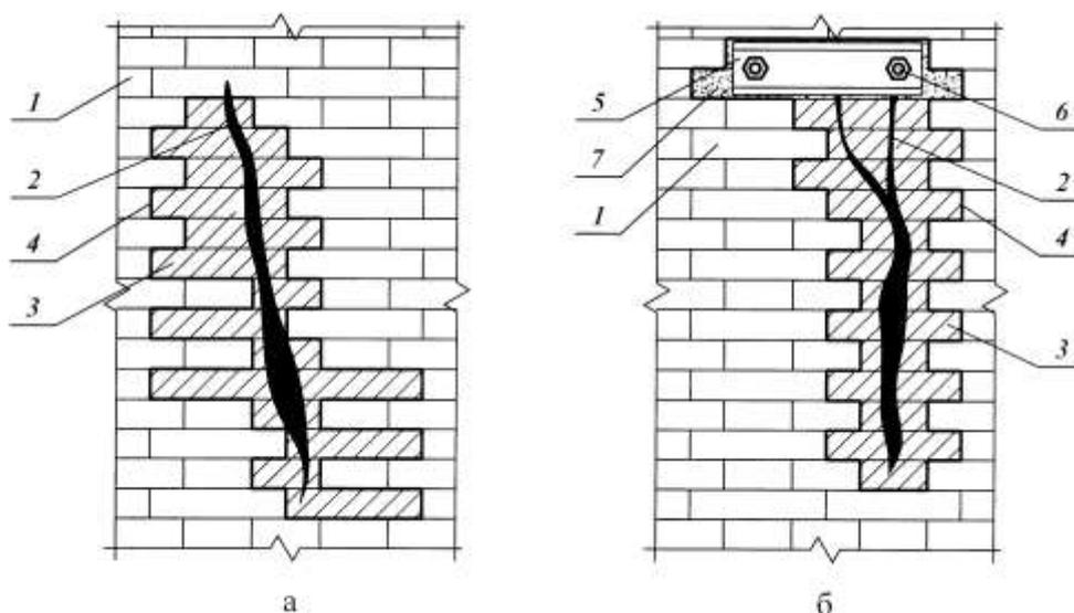
а – с широкими трещинами вставкой простых кирпичных замков; б – то же, вставкой кирпичных замков с якорем; 1 – усиливаемая стена; 2 – трещина в кладке шириной более 10 мм; 3 – кирпичный замок в ½ кирпича; 4 – граница разборки поврежденной кладки; 5 – якорь из прокатного металла; 6 – анкерные связи (болты); 7 – полости заполненные раствором
