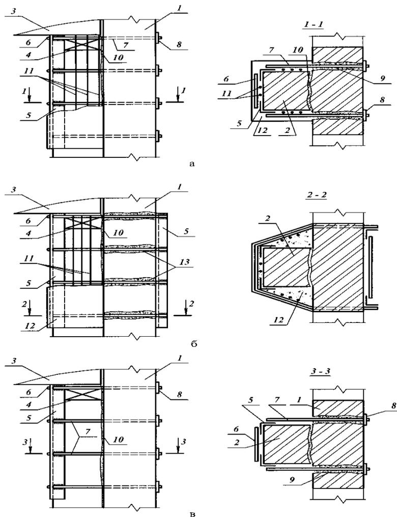
а, б – железобетонных; в – стальных; 1 – простенок; 2 – пилястра; 3 – несущая балка; 4 – опорная подушка; 5 – стальные уголки обоек; 6 – поперечные хомуты обоек из арматурных стержней; 7 – поперечные хомуты - тяжи с гайками; 8 – шайбы; 9 – отверстия в стене (после установки тяжей заполняются цементно-песчаным раствором);
