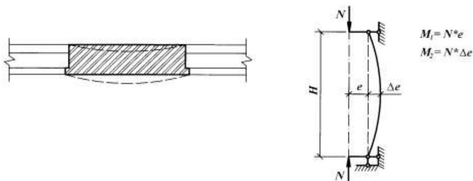
Рисунок 7.1 - Расчетная схема простенка при его выпучивании
