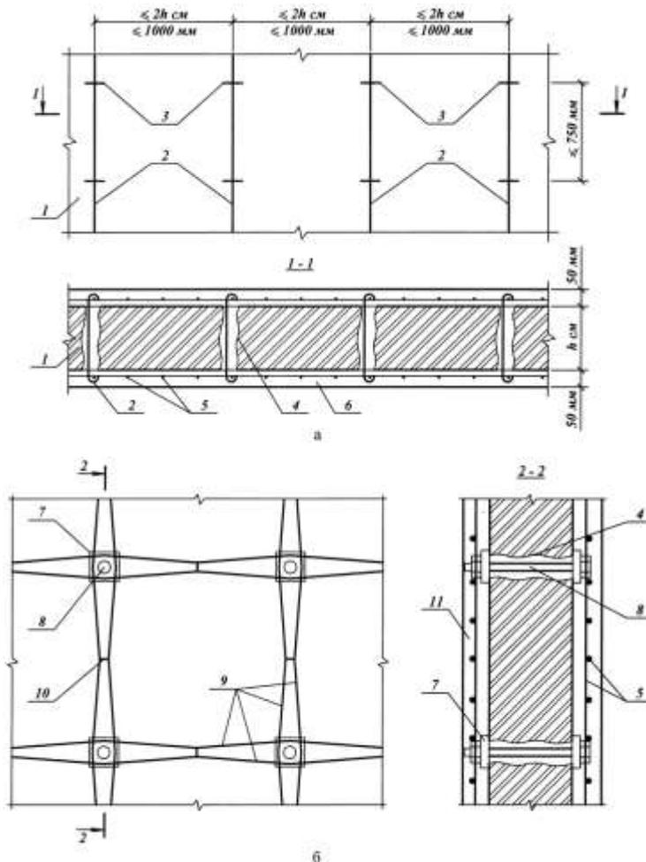
а – железобетонной; б – штукатурной предварительно-напряженной; 1 – усиливаемая стена; 2 – арматурные стержни  $\varnothing 10 \div 14$  мм; 3 – хомуты-связи  $\varnothing 10$  мм; 4 – отверстия в стене; 5 – арматурные сетки, привязанные к арматурным стержням; 6 – бетон обоймы; 7 – стальные пластины с отверстиями для тяжей; 8 – тяжи-связи; 9 – арматурные стержни, приваренные к пластинам и попарно стянутые; 10 – сжимы; 11 – штукатурка из цементно-песчаного раствора
