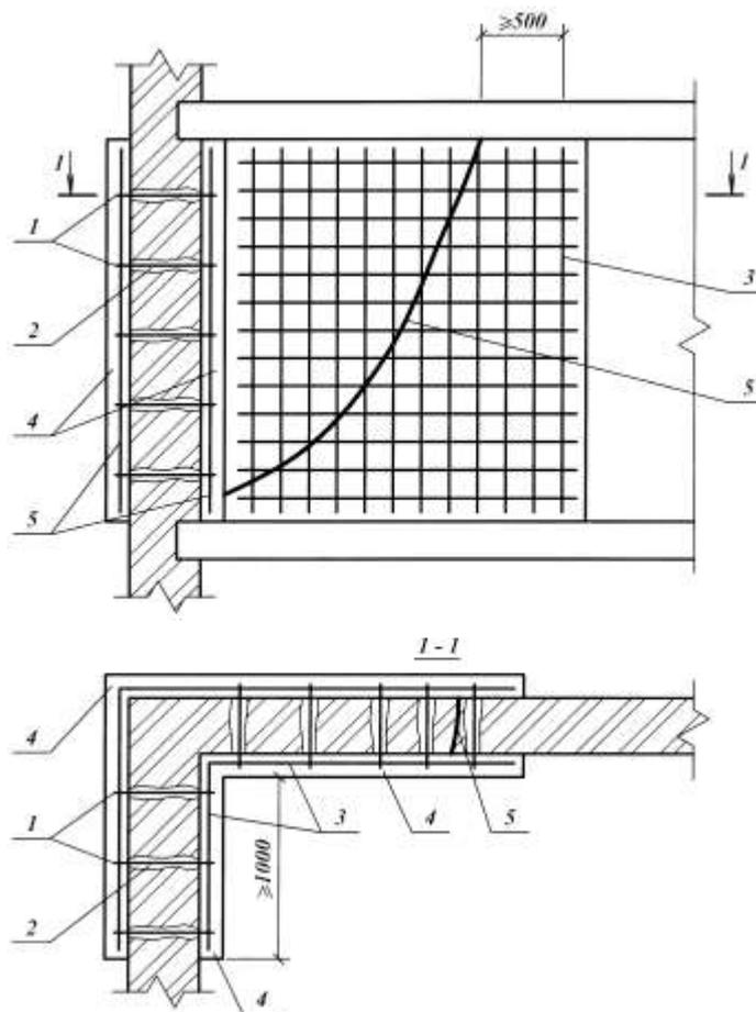
1 – анкеры  $\varnothing$  6 мм; 2 – отверстия в стене; 3 – арматурная сетка; 4 – торкретбетон;
