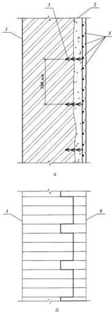
а – оштукатуриванием; б – заменой поврежденной облицовки путем перевязки с существующей кладкой; 1 – кладка стены; 2 – цементно-песчаная штукатурка; 3 – стальные связи (ерши), забиваемые в швы кладки стены через 500 мм по высоте и горизонтали; 4 – арматурная сетка, привязанная к стальным связям; 5 – русты, имитирующие швы каменной кладки; 6 – новая облицовка, перевязанная с существующей кладкой стены (существовавшая отслоившаяся от кладки более 20 мм облицовка удалена)
