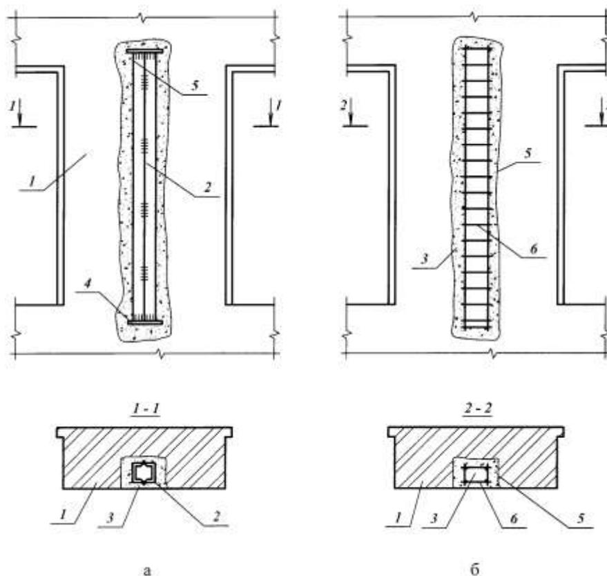
а – сварного из двух швеллеров; б – железобетонного; 1 – усиливаемый простенок; 2 – стальной сердечник; 3 – бетон класса В10...В15; 4 – опорные пластины стального сердечника; 5 – вертикальная ниша, пробитая в простенке; 6 – арматурный каркас
