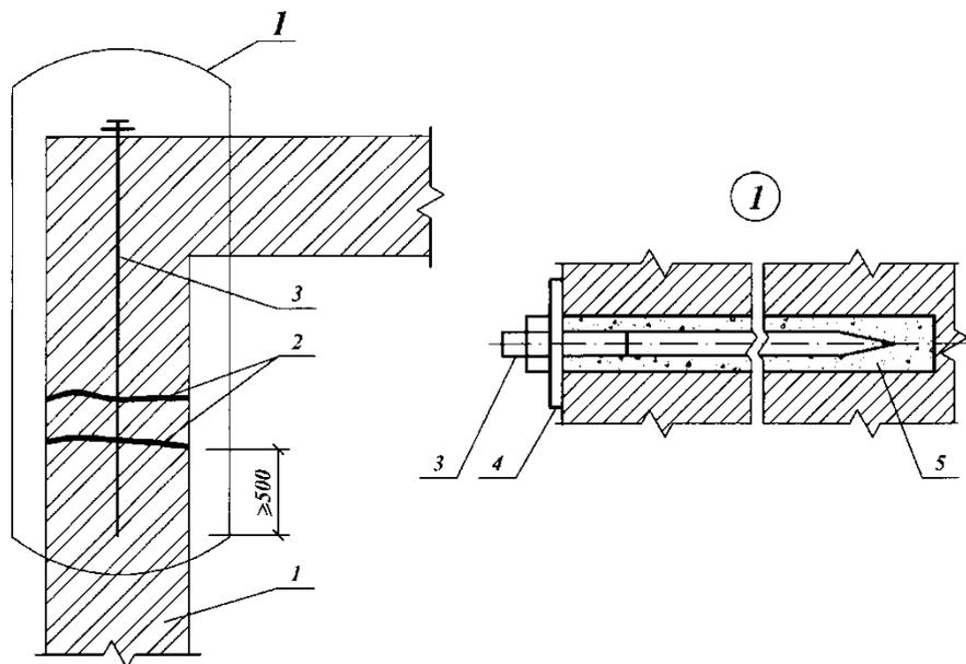
1 – усиливаемая стена; 2 – трещины в кладке стены; 3 – внутренний анкер; 4 – четырехугольные шайбы размером не более 150x150 мм; 5 – отверстия, заполненные цементно-песчаным или полимерцементным раствором
