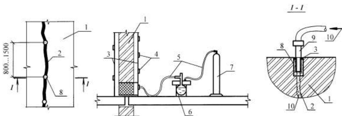
1 – усиливаемая стена; 2 – трещина; 3 – герметизация (пакля на клею); 4 – шайбы; 5 – шланг; 6 – инъекционное устройство; 7 – баллон со сжатым воздухом; 8 – отверстия диаметром 30 мм для установки инъекторов; 9 – инъекторы; 10 – инъекционный состав
