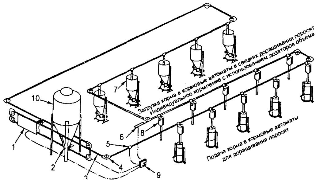
1-привод тросошайбового кормораздатчика; 2 – приемная воронка; 3 – тросошайбовый транспортер; 4 – поворотное устройство; 5 – сенсор отключения подачи кормов; 6 – привод объемных дозаторов кормов; 7 –
