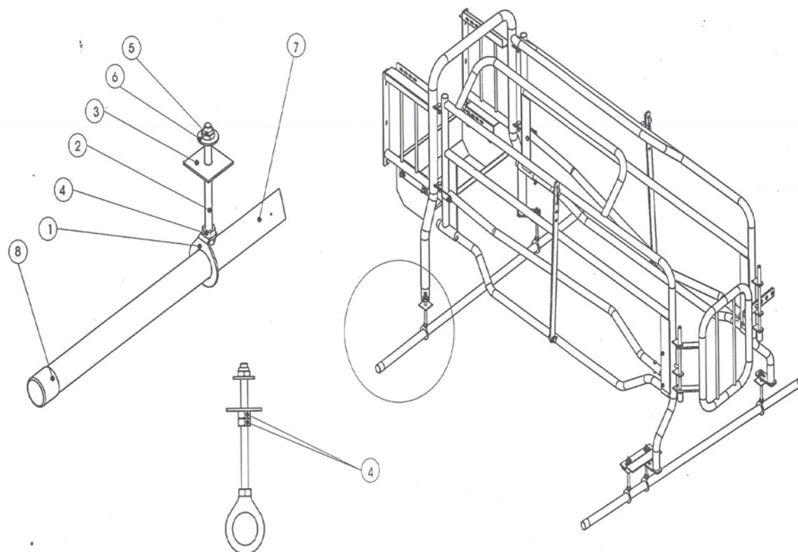
1-крепежный элемент для напольного крепления станка; 2 - болт 6-гранный; 3 – шайба; 4 - болт 6-гранный с головкой; 5 – контргайка; шайба; 7 – труба; 8 – заглушка пластиковая
