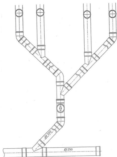
Рисунок 56 – План прокладки труб для системы навозоудаления в помещении с односторонним расположением секций (гребенка)
