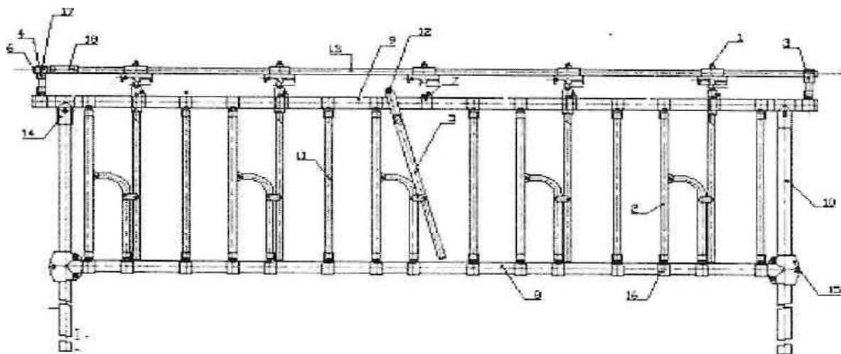
1 – защелка; 2 – рамка фиксирующая; 3 – опора; 4 – опора под ручку; 5 – зажим; 6 – муфта поворотной тяги; 7 – фиксатор; 8 – ригель нижний; 9 – ригель верхний; 10 – стойка; 11 – шейный регулятор; 12 – ролик; 13 – поворотная тяга; 14 – зажим III облегченный; 15 - зажим; 16 - зажим; 17 – ручка; 18 – муфта соединительная
