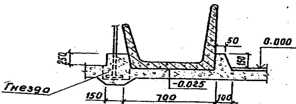
Рисунок 10 Устройство блоков кормушки и стоек ограждения кормового стола (стойл)
