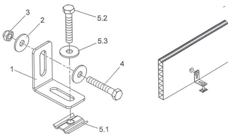
1 – напольный крепежный уголок из нержавеющей стали; 2 – шайба из нержавеющей стали; 3 – контргайка; 4 – болт 6-гранный; 5.1 – анкерное
