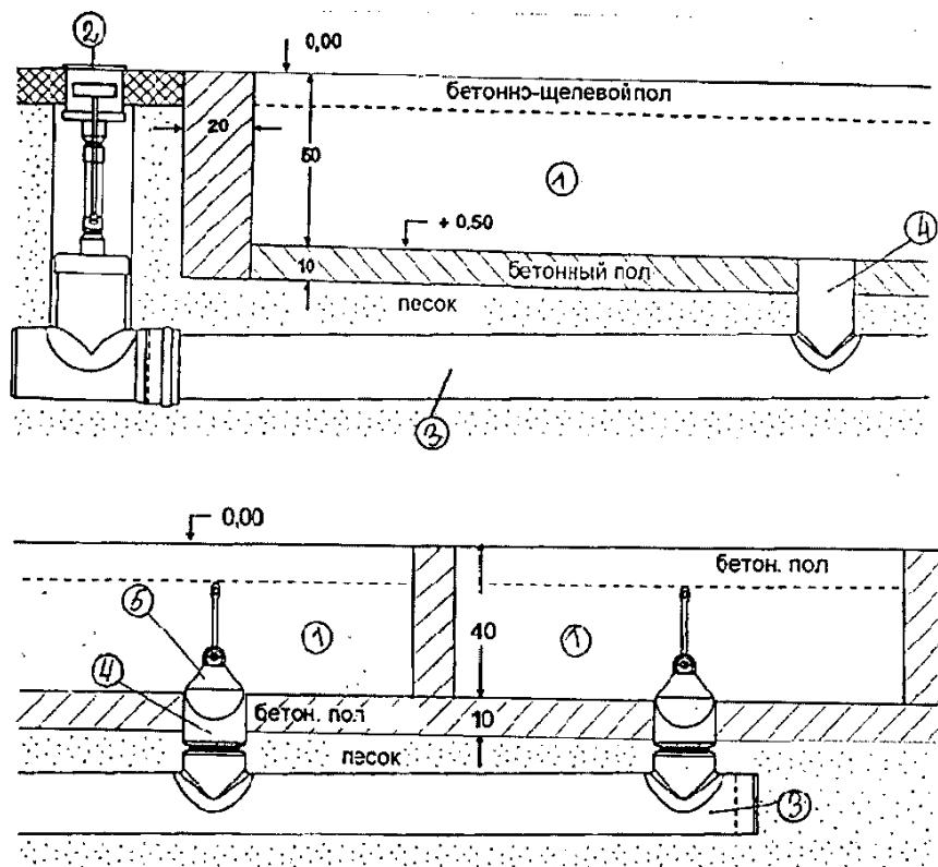
1 – навозонакопительная ванна; 2 – навозоудаляющий клапан; 3 – внутрисекционная труба; 4 – сливная горловина; 5 – шарообразный клапан
