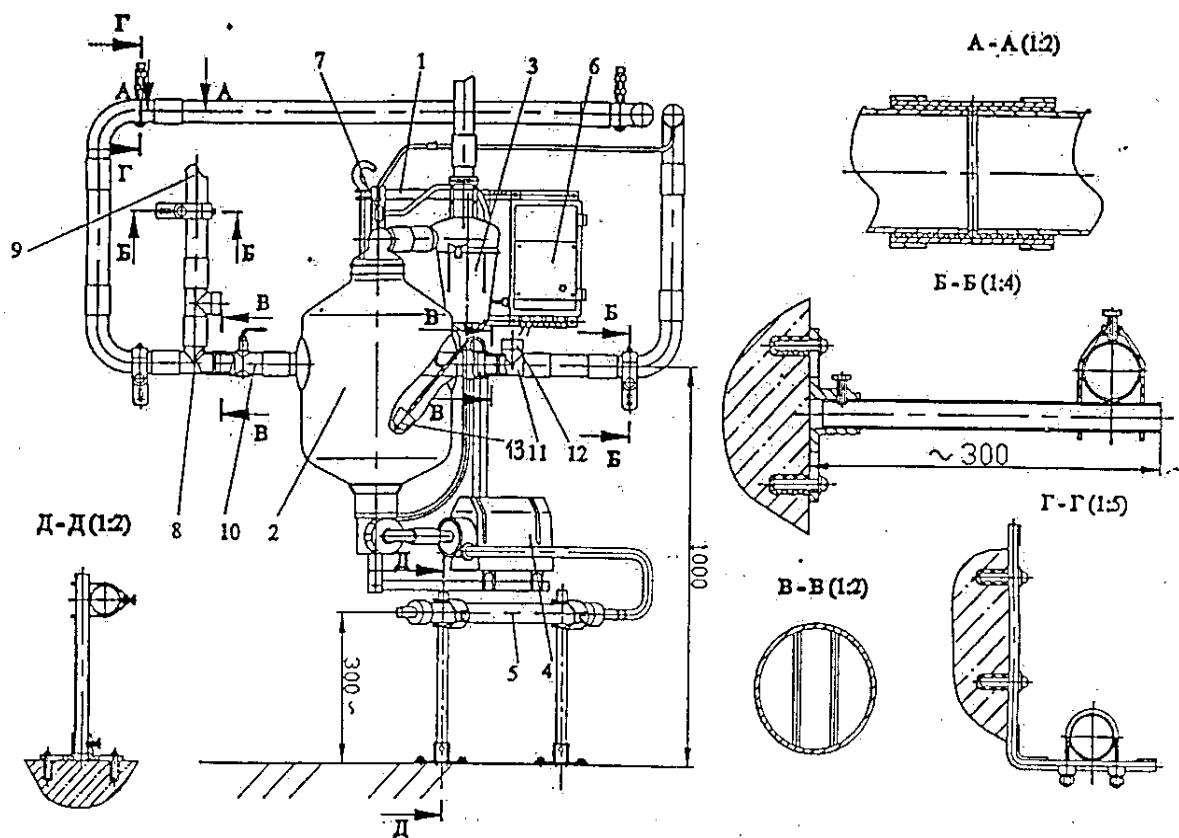
1 – рама; 2 – колба молокосборника; 3 – предохранительная камера; 4 – молочный насос; 5 – фильтр; 6 – многофункциональный блок «Фематроник-С»; 7 – распределитель; 8 – тройник; 9 – промывочная труба; 10 – переключатель; 11 – тройник; 12 – решетка и заглушка; 13 – поплавковый датчик уровня молока
