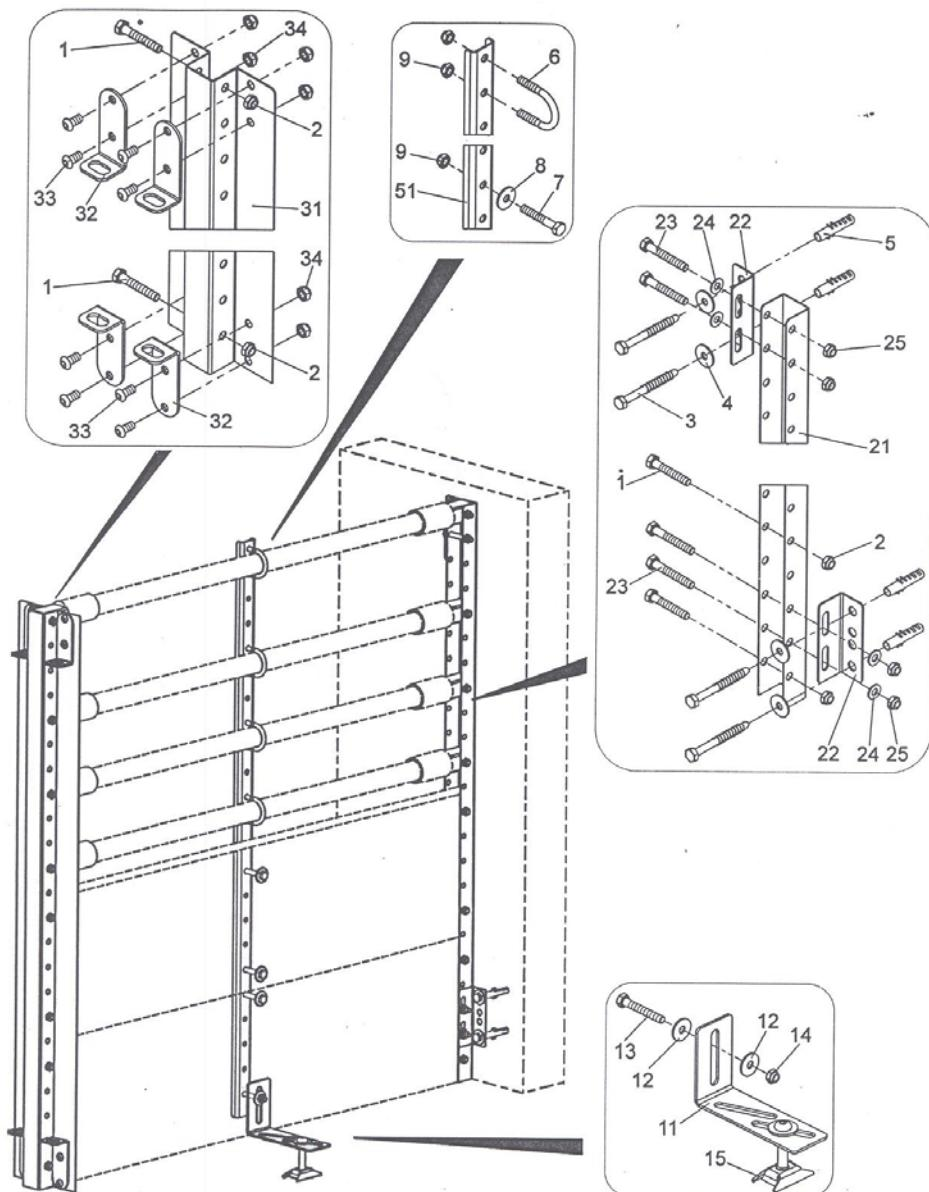
У-образный профиль у стены: 21 - У-образный профиль; 22 – уголок для стен; 23 - болт с 6-гранной головкой; 24 - У-образная шайба сталь; 25 – контргайка; крепёжный комплект для установки у стены;
