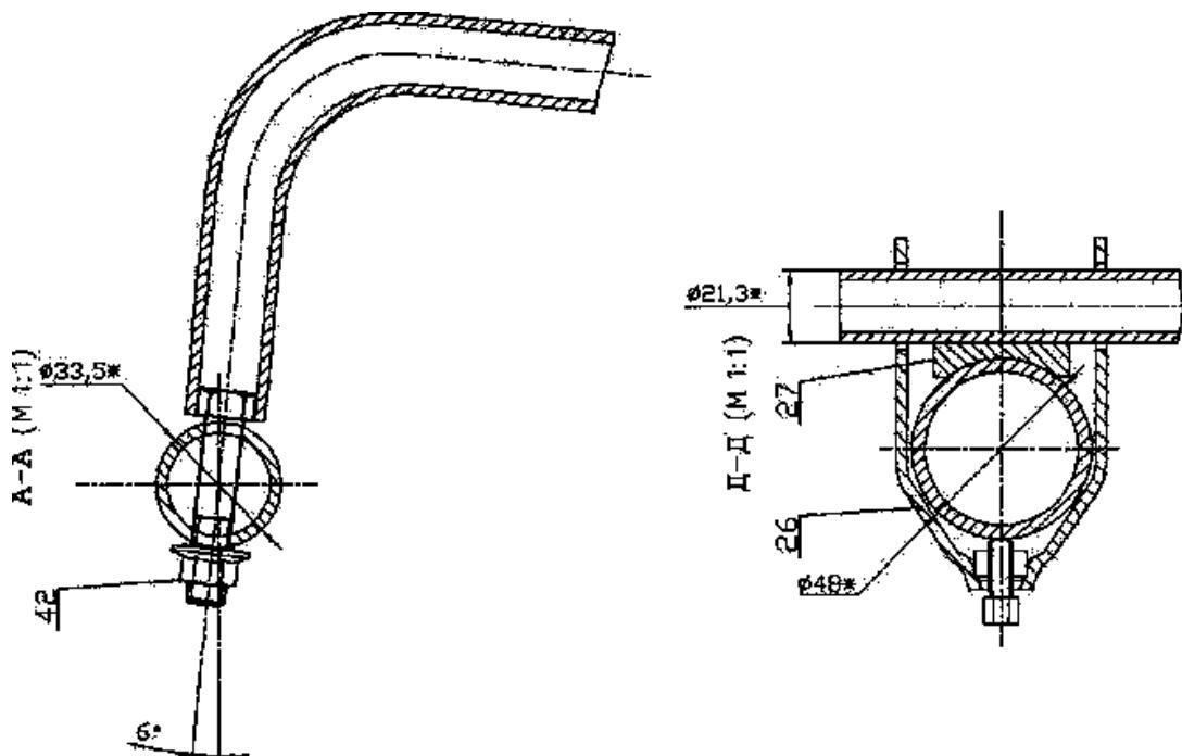
Рисунок 2 - Схемы монтажа крепления к стойкам соединительной и поворотной трубы; крепления к стойкам разделителей стойл и плечевых ограничителей; штырей крепления цепи на поворотной трубе; привода поворотной трубы
