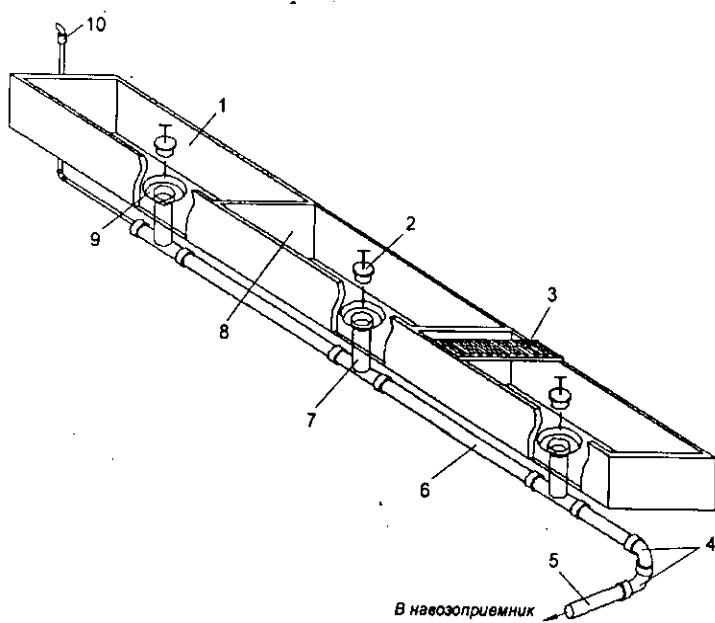
1 – ванна; 2 – задвижка; 3 – решетка; 4 – отвод; 5 – поперечный коллектор; 6 – продольный коллектор; 7 – тройник; 8 – перегородка ванны; 9 – приямок; 10 – воздушный клапан
