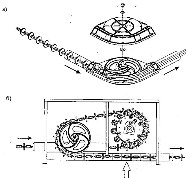
Рисунок 50 – Втягивание транспортерной цепи: а) на поворотных углах; б) протягивание поворотной цепи через привод
