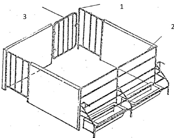
1 – стойка (поставляется с комплектом крепежной арматуры; крепления к полу нижней подставкой, с арматурой крепления верха анкерными болтами; 2- сварные элементы конструкции ограждения станка, поставляемые с болтами
