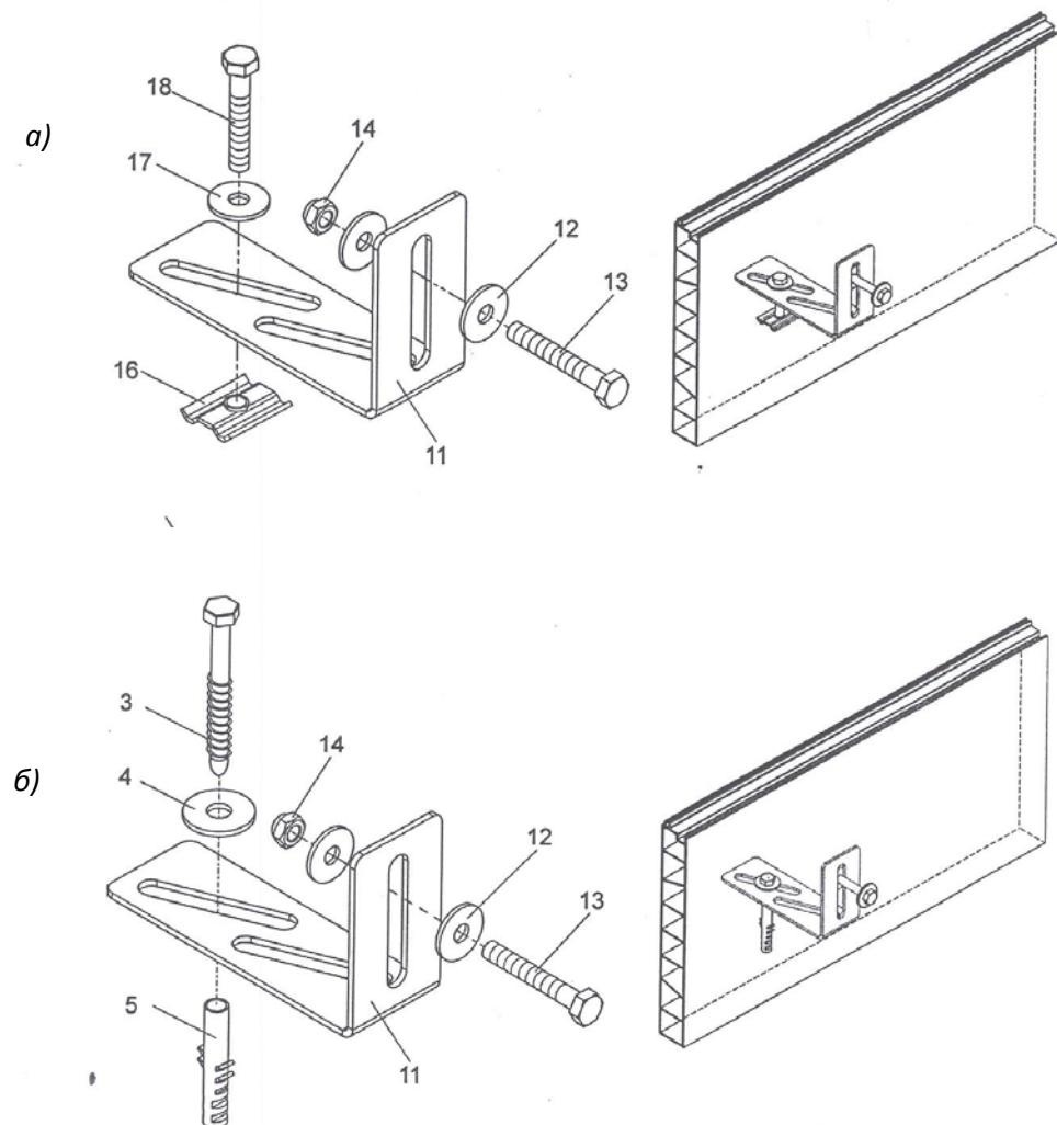
а) 11 – уголок для напольного крепления; 12 – шайба; 13 - болт с 6-гранной головкой; 14 - контргайка; 16 – анкер для щелевых полов; 17 – контршайба; 18 - винт с 6-гранной головкой
