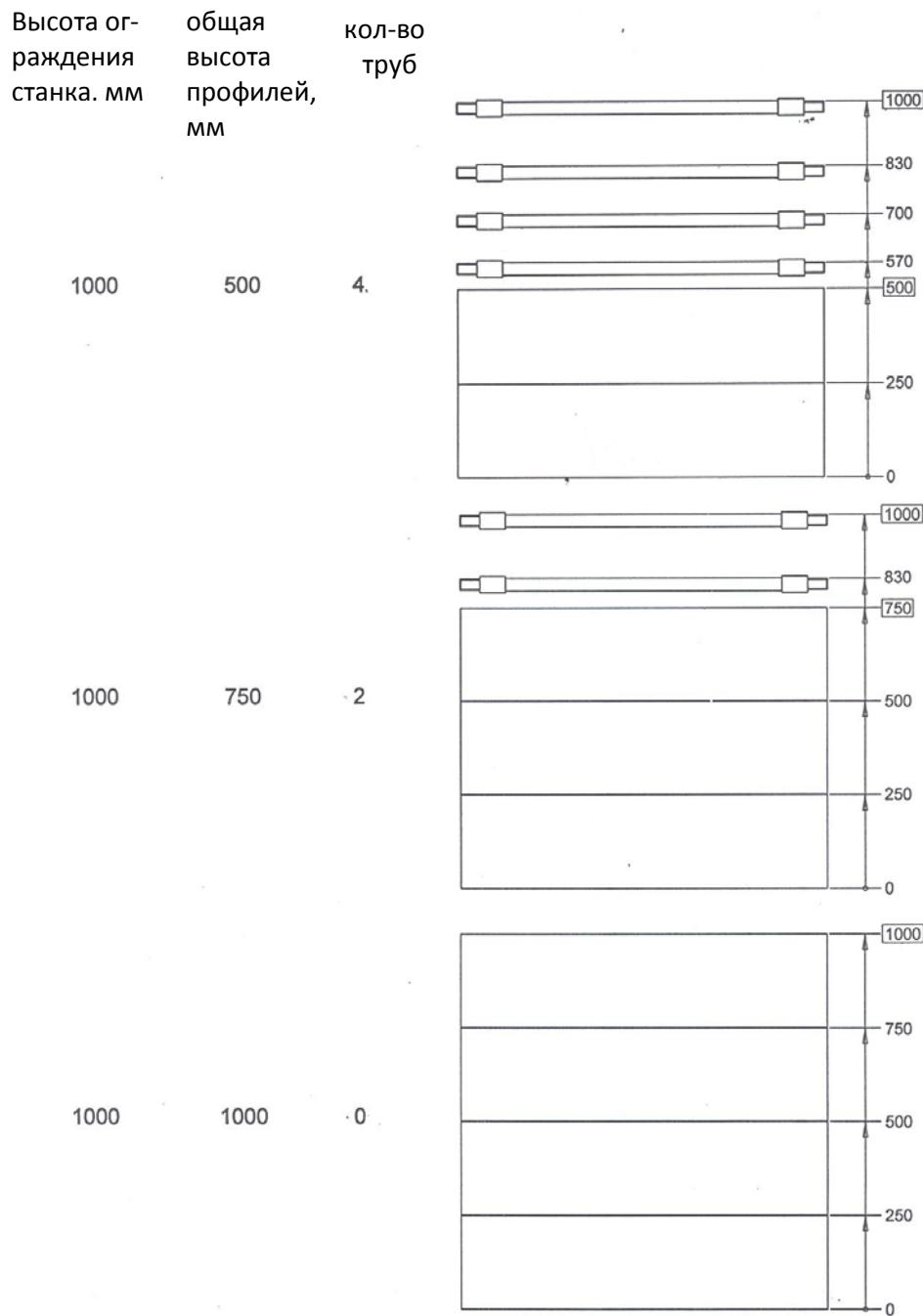
**Рисунок 43 – Варианты элементов ограждений станков для группового содержания свиней на откорме**
