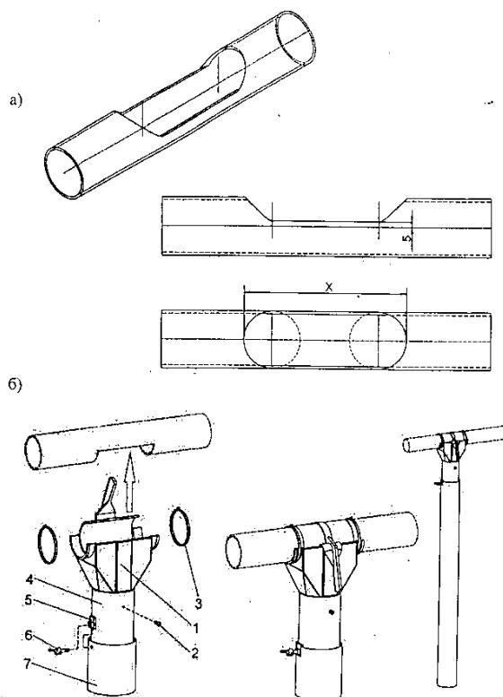
1 – отвод с заслонкой; 2 – шуруп оцинкованный самонарезной; 3 – крепёжная лента для кабеля 280мм; 4 – труба ПХВ прозрачная; 5 – металлическая скоба с гайкой; 6 – барашковый винт; 7 – труба ПХВ прозрачная
