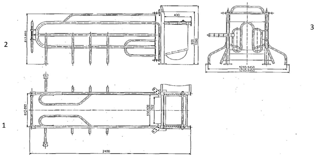
1 – план станка; 2- боковая стенка станка; 3- задняя стенка станка с дверью
