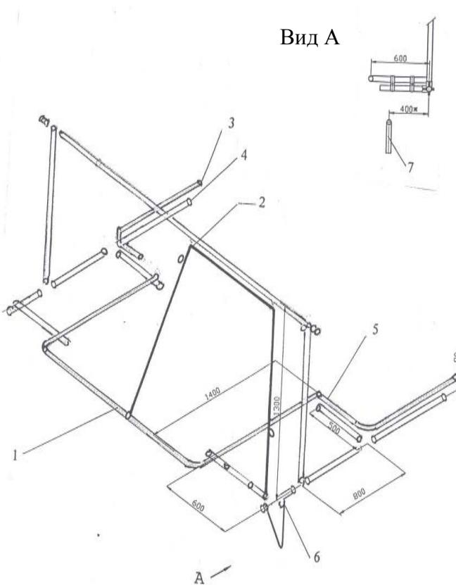
1 – подъемная арка; 2 – ролик; 3 – молокопровод; 4 – вакуумпровод; 5 – муфта поворотная; 6 – кольцо фиксирующее; 7 – стойловое оборудование
