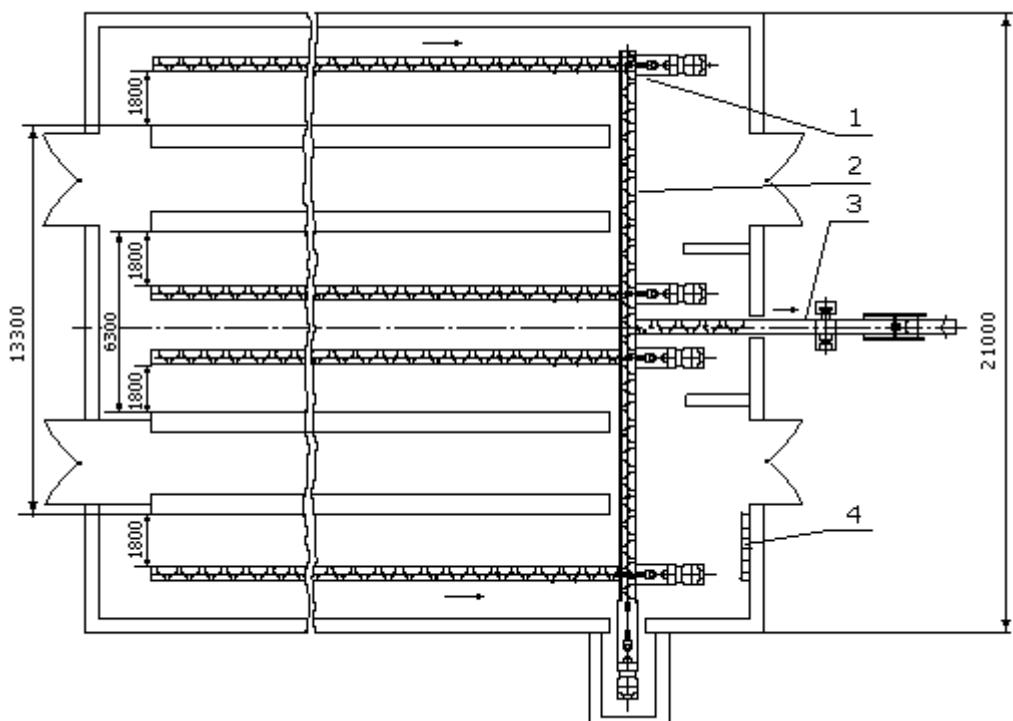
1 – транспортер шнековый продольный; 2- транспортер шнековый поперечный;
