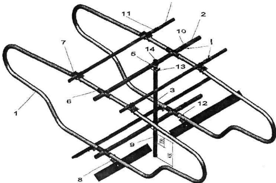
1- разделитель бокса; 2 – ригель; 3 – стойка; 4 – надхолочный брус; 5 – хомут двойной; 6 – зажим облегченный; 7 – скоба крепления надхолочного бруса; 8 – кронштейн крепления подгрудной доски; 9 – полимерная изолирующая вставка; 10 – зажим; 11 – зажим; 12 – хомут; 13 – накладка; 14 – заглушка.
