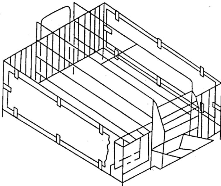
Рисунок 33 - Станок индивидуальный для проведения опороса СОС-Ф35
