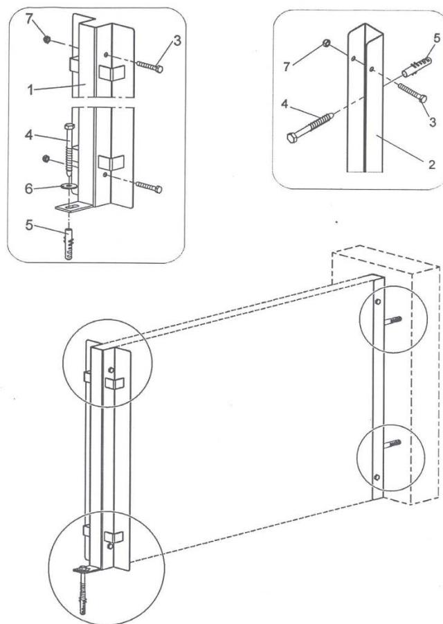
1 – стойка из нержавеющей стали с серьгой для крепления на полу для перегородки; 2 – U-образный профиль из нержавеющей стали для перегородки бокса; 3. 4 – болты 6 - гранный; 5 - дюбель 10; 6 – шайба; 7 – контргайка;
