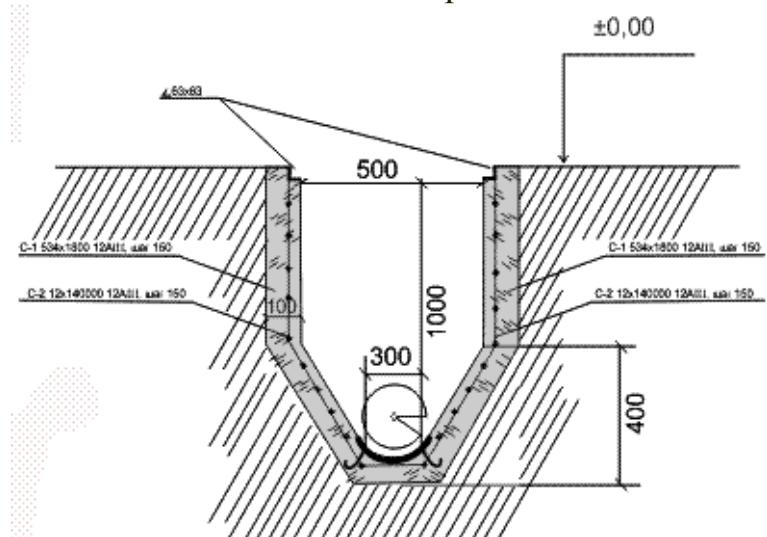
Рисунок 28 Канал шнекового транспортера. Разрез
