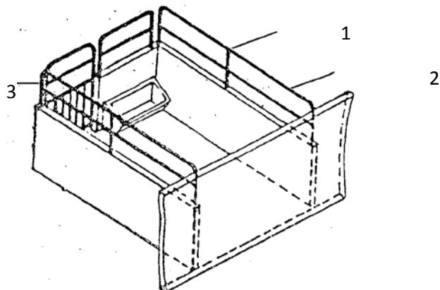
1 – стойка (поставляется с комплектом крепежной арматуры; крепления к полу нижней подставкой, с арматурой крепления верха анкерными болтами; 2- сварные элементы конструкции ограждения станка, поставляемые с болтами для стоек (расчетная панель длиной 75 см); 3- сварная дверь, поставляемая с петлями и замками без стоек.
