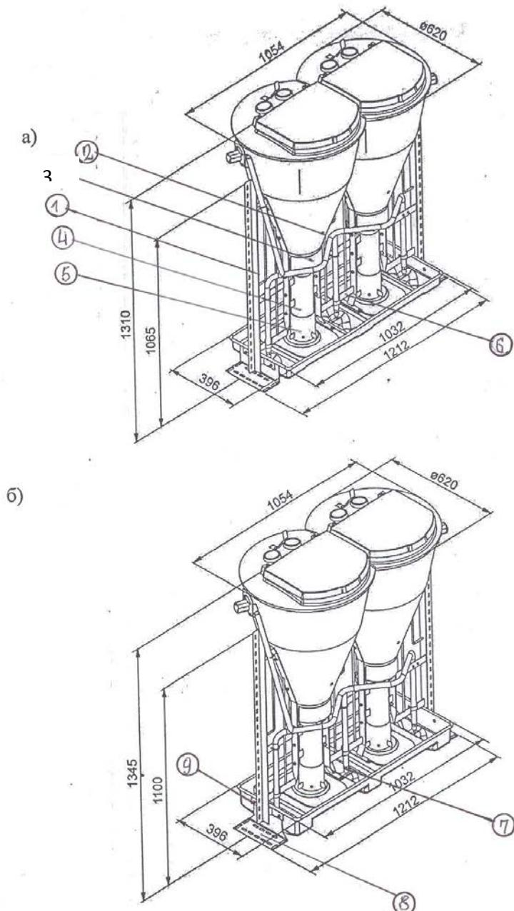
1 – рама из нержавеющей стали для кормового автомата; 2 – кормушка из нержавеющей стали для кормового автомата; 3 – опорное кольцо ёмкости для корма; 4 – кормовая труба с пластиковым воротником; 5 – подвижная деталь кормовой трубы; 6 – средняя рама; 7 – ниппель для поилки диаметром  $\frac{1}{2}$  дюйма; 8 – угол напольного крепления для кормового автомата; 9 – контргайка
