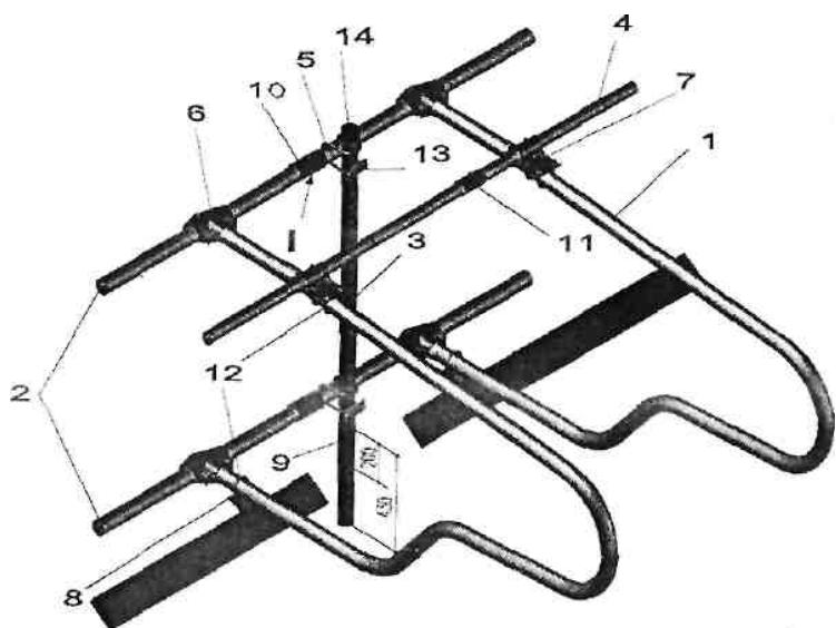
1- разделитель бокса; 2 – ригель; 3 – стойка; 4 – надхолочный брус; 5 – хомут двойной; 6 – зажим облегченный; 7 – скоба крепления надхолочного бруса; 8 – кронштейн крепления подгрудной доски; 9 – полимерная изолирующая вставка; 10 – зажим; 11 – зажим; 12 – хомут; 13 – накладка; 14 – заглушка.
