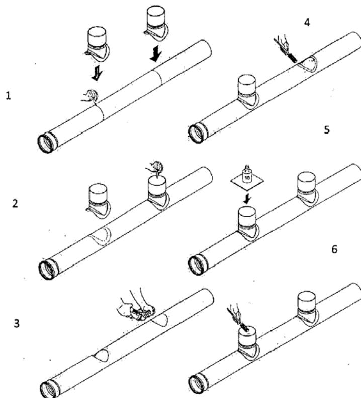
1 – замерка гнезда для горловины; 2 – размещение горловины на середине размеченной линии и разметка на трубе внутреннего и внешнего диаметра горловины; 3 – вырезка гнезда электрическим пібзиком; 4 – нанесение клея вокруг гнезда; 5 – насадка горловины на трубу; 6 – проклейка стока с внутренней стороны
