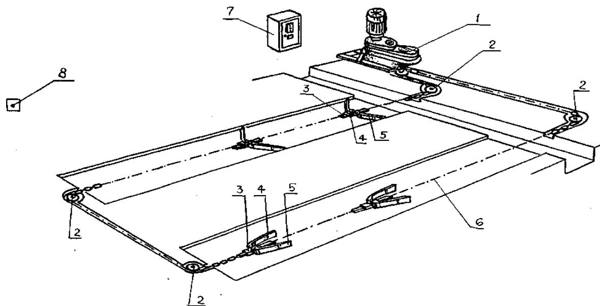
1 - привод с механизмом реверсирования; 2 - поворотные устройства; 3, 4, 5 – рабочие органы; 6 - цепного контура; 7 - ящика управления; 8 – кнопочное устройство
