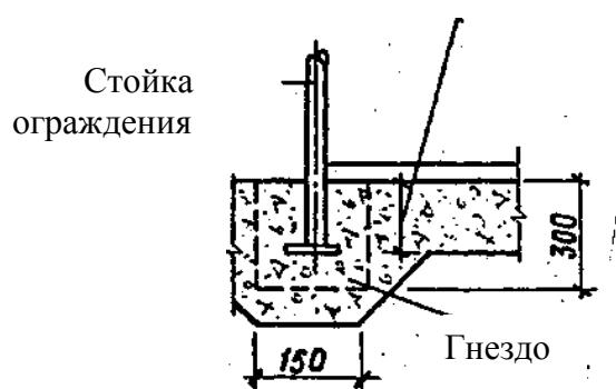
Рисунок 4 Устройство стоек пристенных боксов
