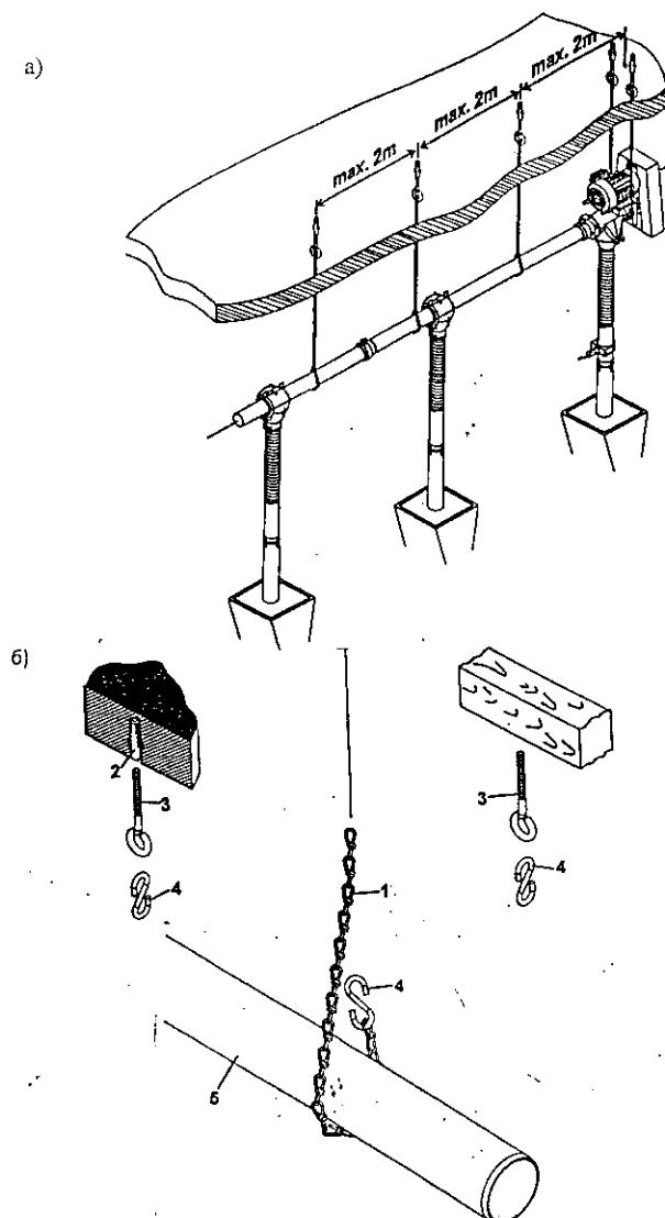
1 – подвесная цепь; 2 – дюбель; 3 – монтажный крюк; 4 – S-крюк диаметром 2 дюйма; 5 – подающая труба
