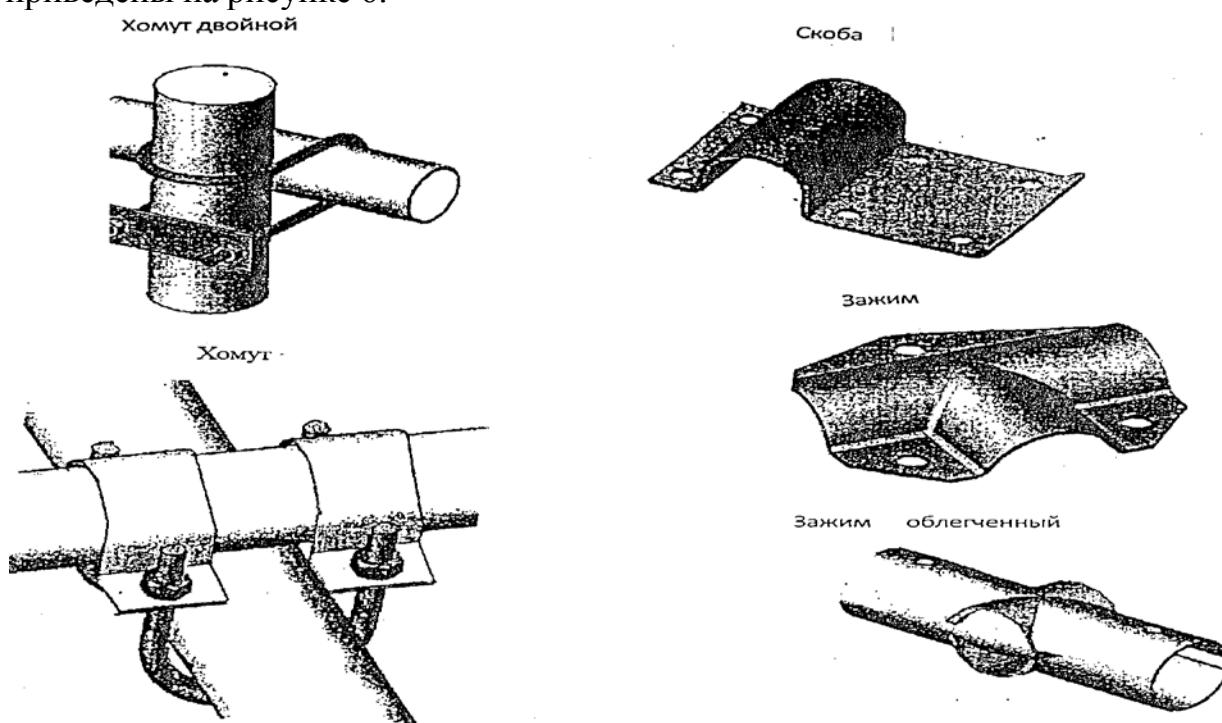
4.2.13 Монтаж ограждений секций (клеток с групповым содержанием крупного рогатого скота), осуществляется из оцинкованных труб по ГОСТ 3262. Диаметр труб, как правило, 40-50 мм, толщина 3,5 мм. Длина труб зависит от ширины секции (по проекту). Глубина секций не более 3 м.
