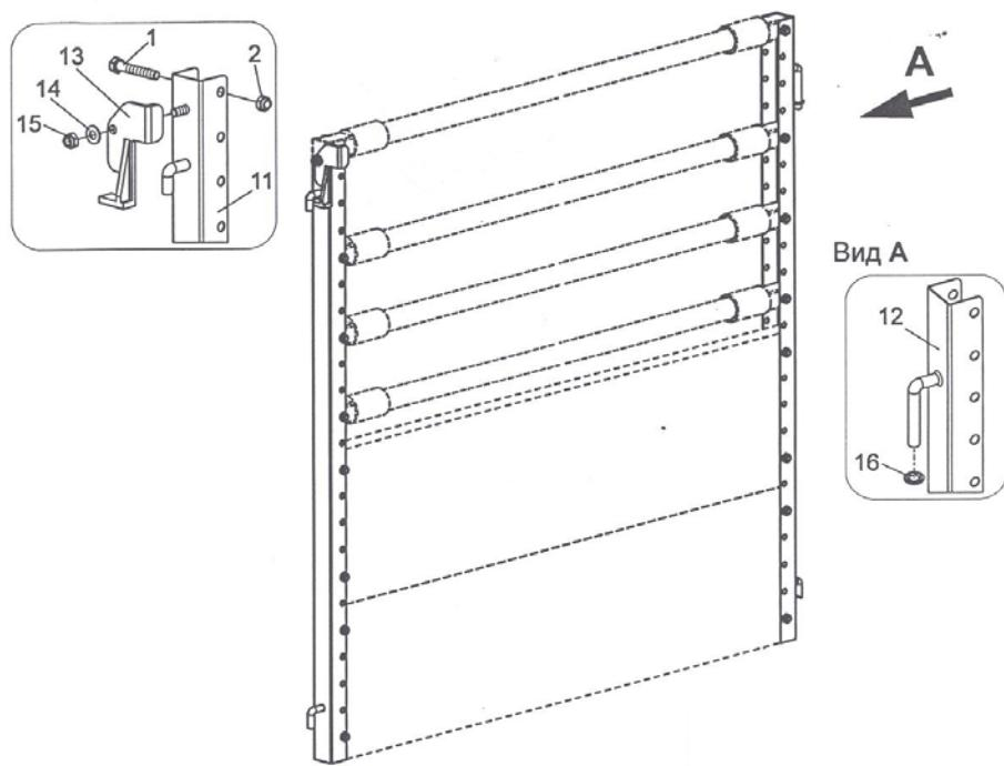
Крепёжный комплект: 1 – болт с 6-гранной головкой; 2 – контргайка; 11 – дверная стойка; 12 - дверная стойка; 13 – задвижка для обслуживания одной рукой, левая; 14 - U-образная шайба сталь; 15 - контргайка; 16 – пружинное кольцо
