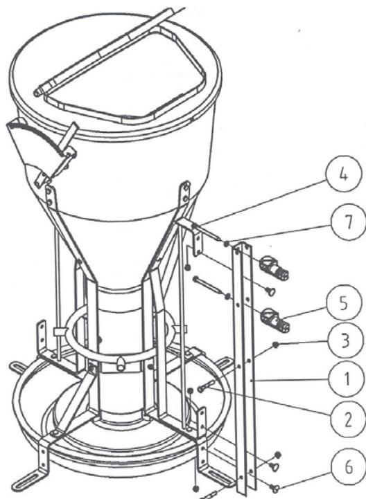
1 – стойка ограждения оцинкованная; 2 – 6-гранный винт; 3 – 6-гранная гайка; 4 – съемный винт; 5 – распорный дюбель для трубы Ø34; 6 – винт дверной петли; 7 – шайба для винта
