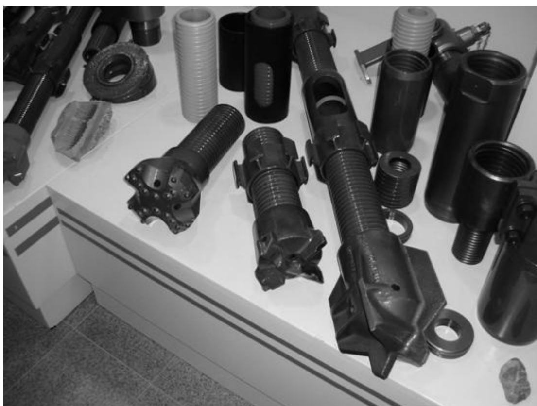
Рисунок 7.19 – Типы буровых коронок, трубчатых винтовых штанг и соединительных элементов
