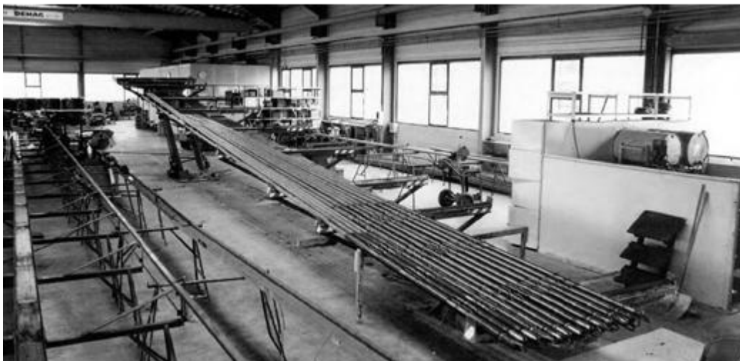
Рисунок 10.7 - Комплектация конструкции анкера на наклонном стенде *
