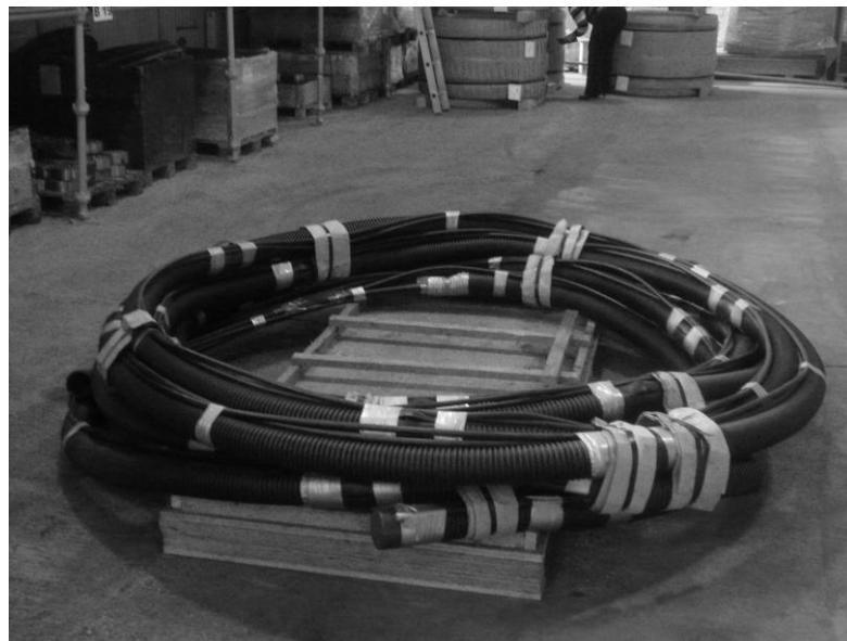
Рисунок 10.5 – Анкер из арматурных канатов в гофрированной трубе-оболочке в транспортном положении
