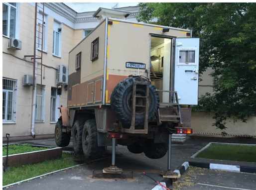
Испытания зондами FUGRO TR-CPTU и S-CPTU на опытной площадке АО "НИЦ "Строительство"
