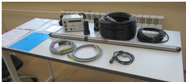
Комплект оборудования ПИКА-19К (зонд с дополнительным датчиком гамма-каротажа)
