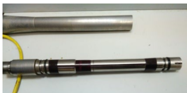
Наконечник зонда с тензосистемой разностного типа в разобранном виде
