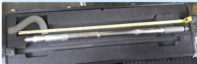
Зонд S-CPTU (FUGRO) с дополнительными датчиками порового давления и сейсмодатчиками
