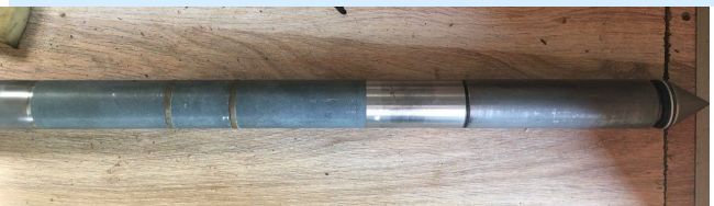
Зонд TR-CPTU (FUGRO) с дополнительными датчиками порового давления, температуры и электропроводности грунта
