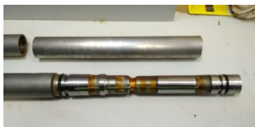
Наконечник зонда с тензосистемой раздельного типа в разобранном виде
