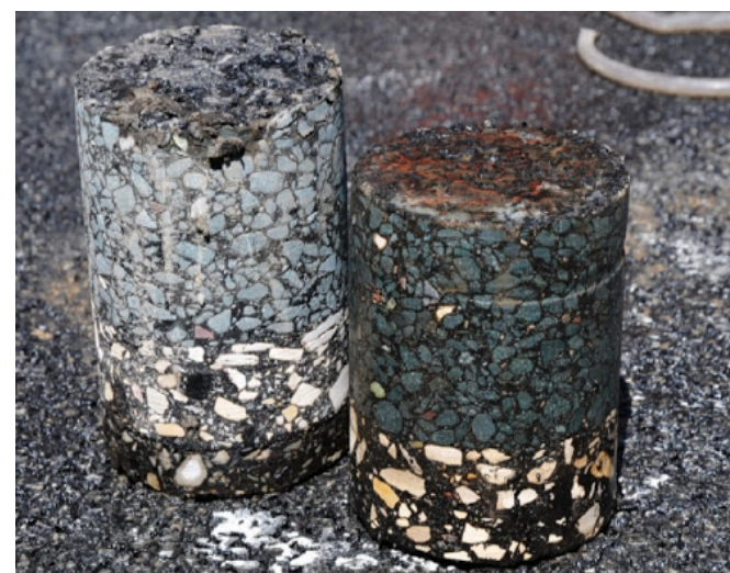
Контроль за производством работ по ремонту дорожного покрытия по Московскому проспекту (укладка щебеночно-мастичного покрытия)
