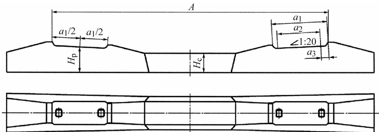
Рисунок 7 – Схема шпал типа I
