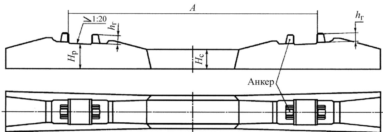
Рисунок 8 – Схема шпал типа II
