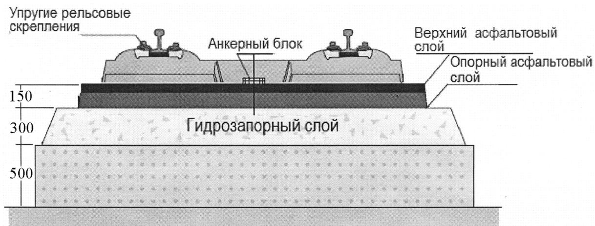
Рисунок 2 – Система безбалластного пути с точечной опорой и шпалами, уложенными на асфальтовый (бетонный, асфальтобетонный) опорный слой
