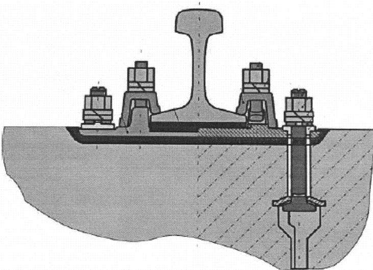
Рисунок 11 – Жесткое раздельное рельсовое крепление для железобетонных шпал
