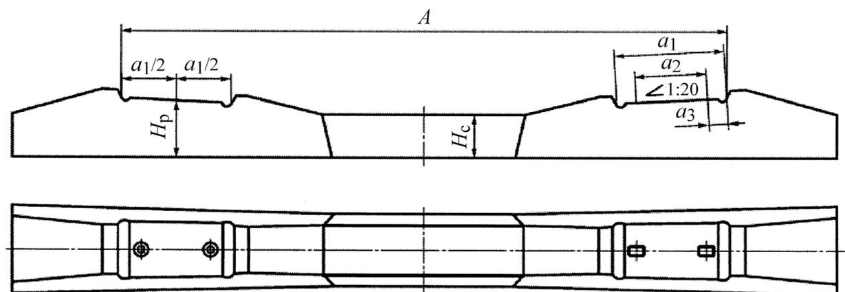
Рисунок 9 – Схема шпал типа III
