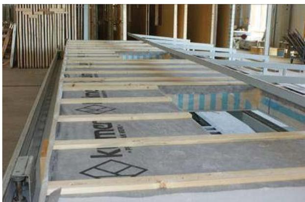
Рис. 1. Изготовление и монтаж крупных панелей фасада реконструируемого здания в г. Грац (Австрия). Фото предоставлены фирмой Gap-solution GmbH, Austria
