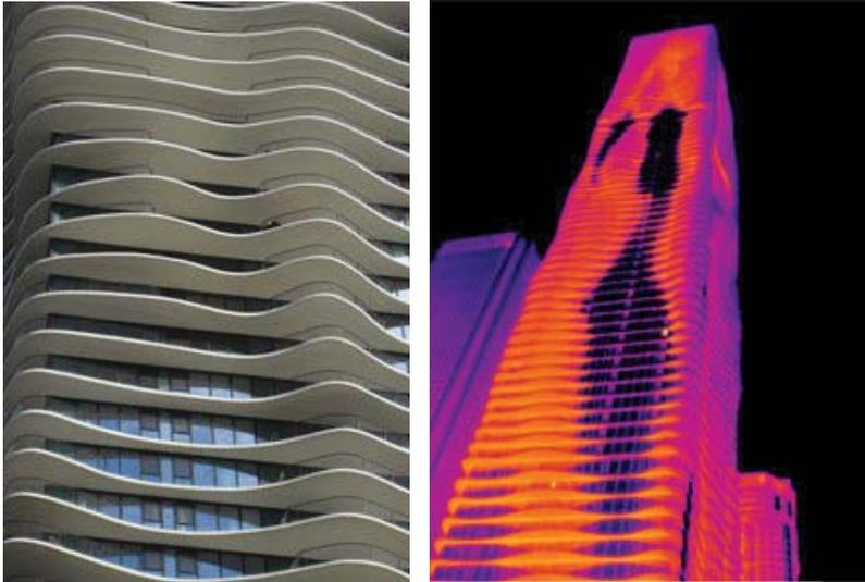
Рис. 1. Пример тепловых мостов: «Аква-башня», Чикаго. Изображения сделаны термографом корпорации Fluke, предоставлены Building Science Corporation и Дэйвом Робли
