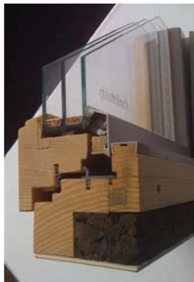
Рис. 4. Двухкамерное теплоизолированное окно (Optiwin, Австрия и Германия). Конструкция рамы включает термические прокладки из пробки и теплоизоляционной пены,  $U_w = 0,70 \text{ Вт/(м}^2 \text{ K)}$
