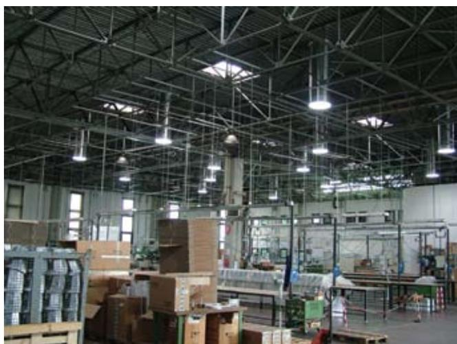
Рис. 3. Световые трубы обеспечивают естественное освещение на складе
