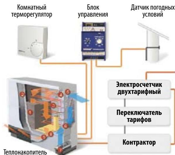
Рис. 1. Принципиальная схема работы теплогенерирующего отопительного прибора
