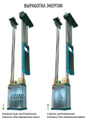
Рис. 2. Схема выработки электроэнергии
