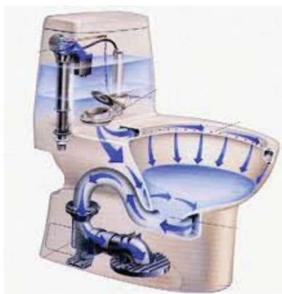
Рис. 2. Схема унитаза с низким расходом воды
