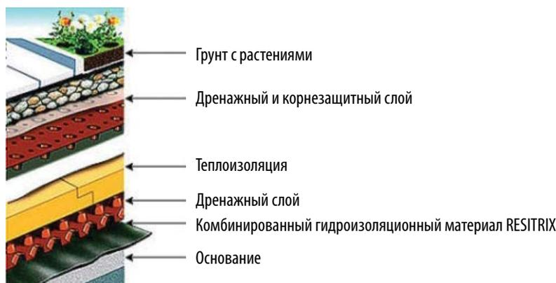
Рис. 1. Принципиальная схема устройства «зеленой» кровли
