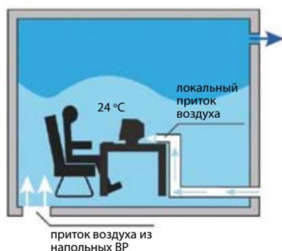
Рис. 1. Локальная вентиляция с помощью специальных устройств
