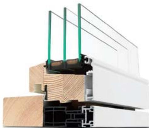
Рис. 2. Энергоэффективные двухкамерные окна Classic + (PRO TEC, Дания). Коэффициент теплопередачи  $U_w = 0,77 \text{ W/m}^2\text{K}$
