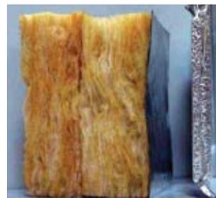
Рис. 2. Слева — мат из минеральной ваты, справа — вакуумная теплоизоляционная панель. Термическое сопротивление — одинаковое
