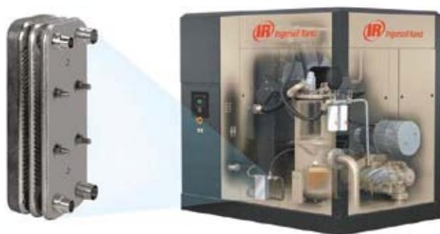
Рис. 3. Теплообменник класса «охлаждающая жидкость-вода» Ingersoll Rand ERS использует тепловую энергию, содержащуюся в охлаждающей компрессор жидкости, для нагрева воды до 70 °С
