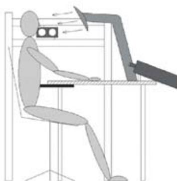
Рис. 2. Влияние локальной (индивидуальной) вентиляции на комфортное состояние человека с помощью CFD-моделирования и инструментальных измерений на манекенах
