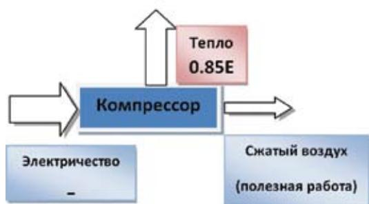
Рис. 1. Энергетический баланс компрессора для производства сжатого воздуха
