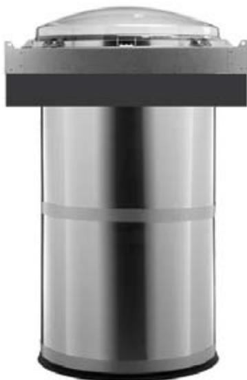
Рис. 1. Световая труба SkyVault — устройство, обеспечивающее естественное освещение больших помещений с высокими потолками. Труба диаметром 74 см выпускается длиной до 30 м (Solartube International)
