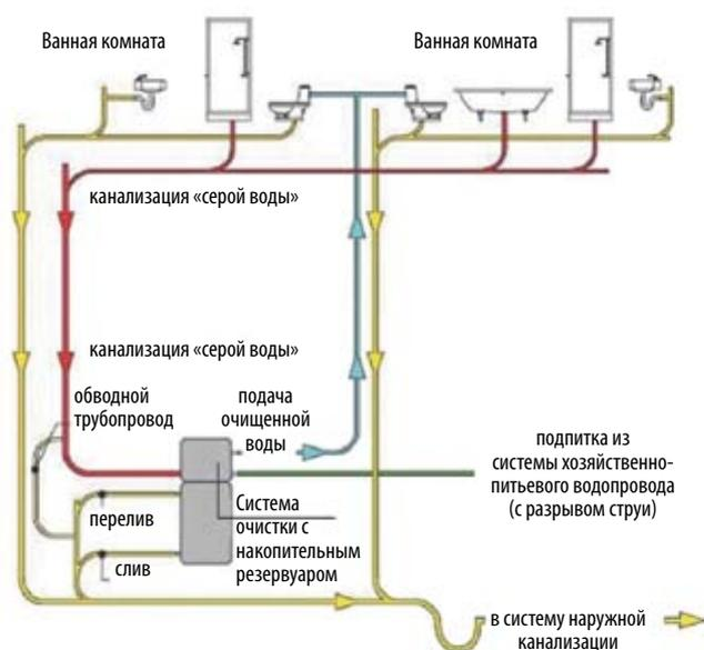
Рис. 1. Принципиальная схема оборотного водопровода
