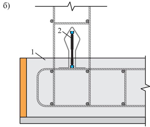
1 – участок конструкции; 2 – гидрошпонка
