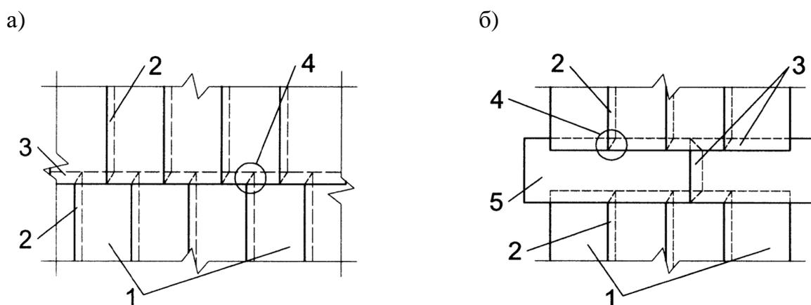
а) – укладка полотен со смещением стыков; б) – укладка полотен на сборную полосу
