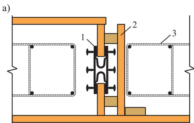
1 – гидрошпонка; 2 – элемент опалубки;
