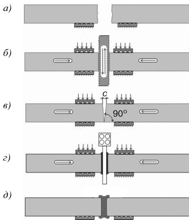
а) – центровка и закрепление в зажимах сварочного устройства концов свариваемых гидрошпонок или фасонных элементов; б) – механическая обработка торцов гидрошпонок и фасонных элементов с помощью торцовки; в) – проверка точности совпадения торцов по величине зазора  $c$ ; г) – нагрев (оплавление) свариваемых торцов с помощью нагретого инструмента; д) – осадка стыка до образования сварного соединения
