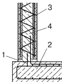
1 – гидрошпонка; 2 – монолитная фундаментная плита; 3 – сборный элемент несъемной опалубки стены; 4 – монолитный бетон
