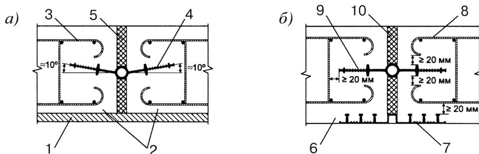
а) – фундаментная плита сооружения; б) – контурная стена
