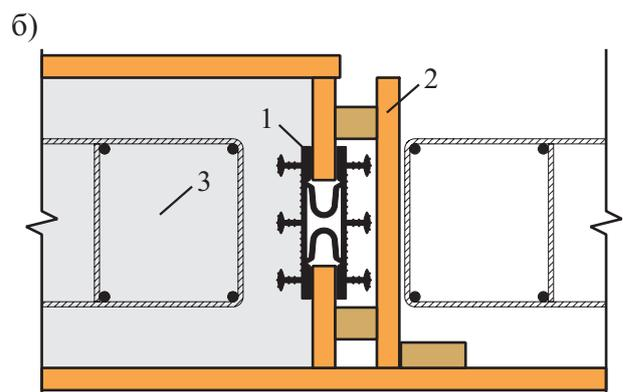
1 – гидрошпонка; 2 – элемент опалубки;
