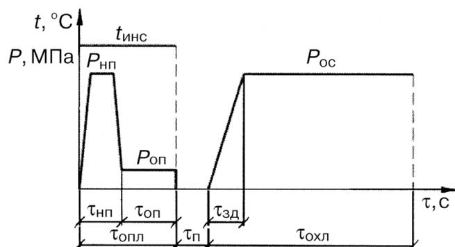
Рисунок Ж.2–Циклограмма процесса контактной сварки встык
