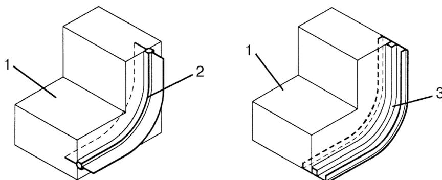
1 – бетон; 2 – гидрошпонка, тип ДВ или ХВ; 3 – гидрошпонка, тип ДО, ХО или ДЗ
