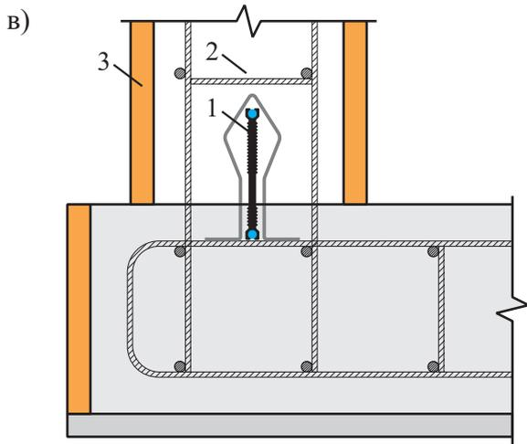
1 – гидрошпонка; 2 – смежный участок конструкции; 3 – элемент
