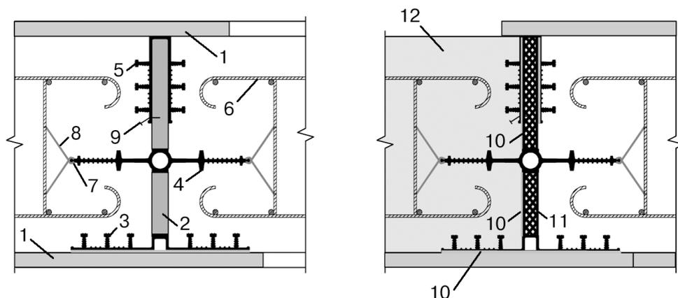
1 – опалубка стены; 2 – торцевая опалубка; 3 – гидрошпонка, тип ДО; 4 – гидрошпонка, тип ДВ; 5 – гидрошпонка, тип ДЗ; 6 – арматурный стержень; 7 – крепежная скоба; 8 – вязальная проволока; 9 – гвоздь; 10 – клеевой состав; 11 – заполнитель шва; 12 – бетон
