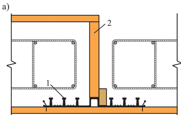
1 – гидрошпонка; 2 – элемент опалубки
