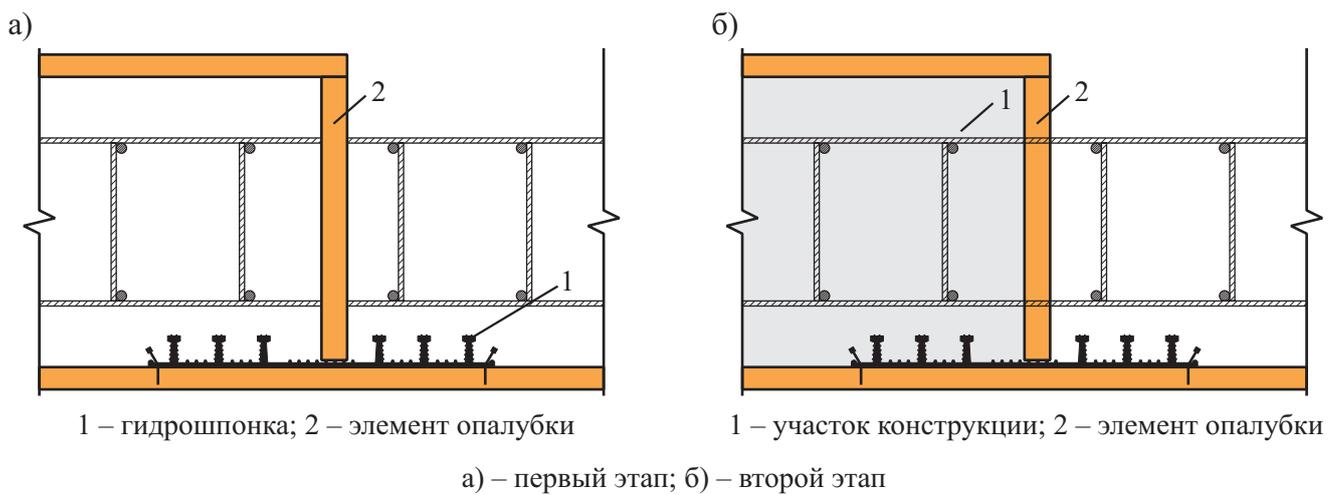
Рисунок К.8 – Этапы работ по установке гидрошпонок типа ХО (Лист 1)
