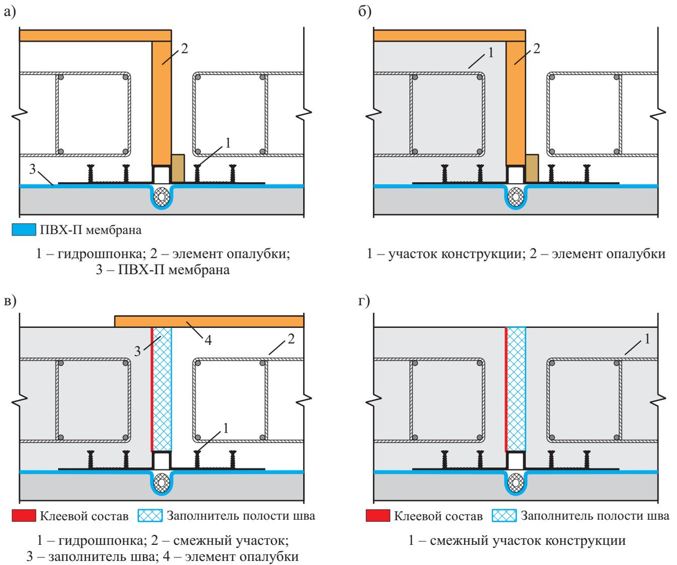
Рисунок К.9 – Этапы работ по установке гидрошпонок типа ДОМ
