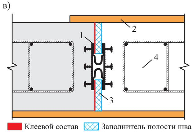
1 – гидрошпонка; 2 – элемент опалубки;
