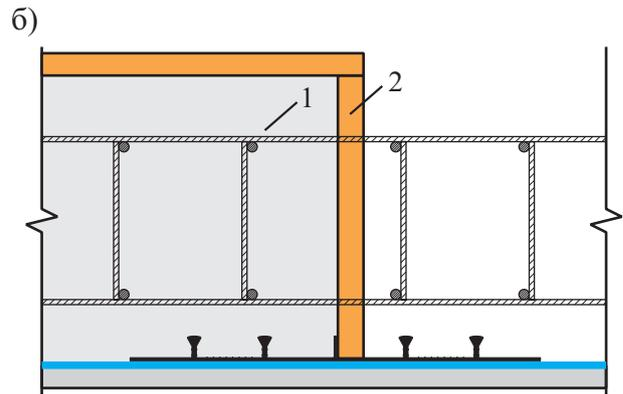
1 – участок конструкции; 2 – элемент опалубки
