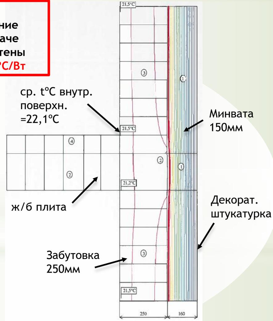
Приведенное сопротивление теплопередаче  $R=5,34 \text{ м}^2\text{°C/Вт}$
