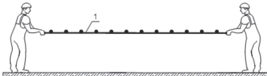
Установка нижних сеток
