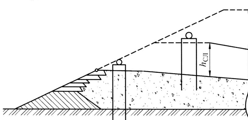
Рисунок 13 – Эстакадный способ намыва сооружений
