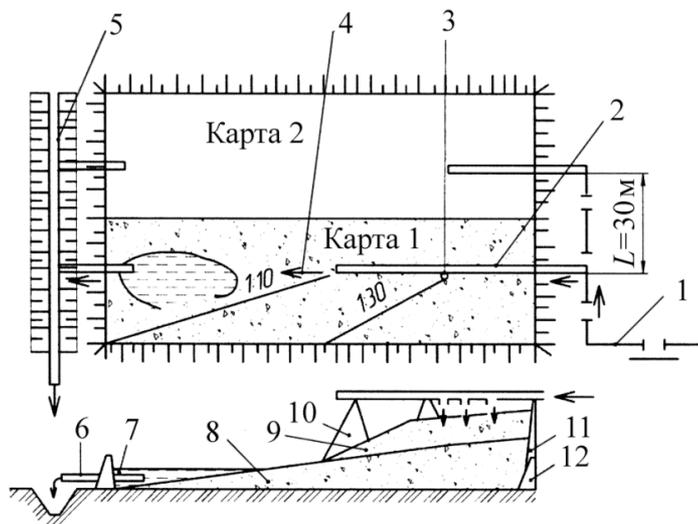
1, 2 – пульпопроводы магистральный и распределительный; 3, 4 – выпуски пульпы на карту дополнительный и торцевой; 5 – водосборная канава; 6 – водосбросная труба; 7 – прудок-отстойник; 8, 9 – пляж намыва из выпусков торцевого и дополнительных; 10 – эстакада; 11, 12 – дамбы обвалования попутная и первичная
