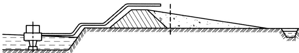
Рисунок 15 – Подача гидросмеси за дамбу обвалования
