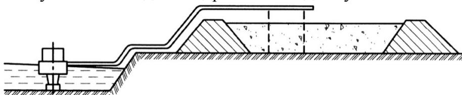
Рисунок 16 – Подача гидросмеси на площадь между дамбами обвалования
