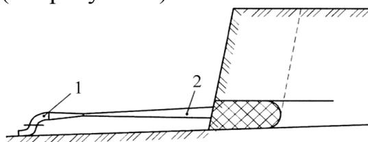
1 – гидромонитор; 2 – струя воды
