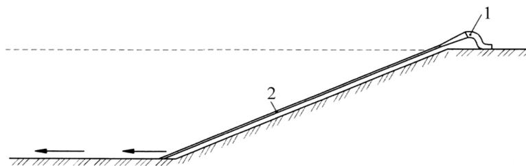
1 – гидромонитор; 2 – струя воды
